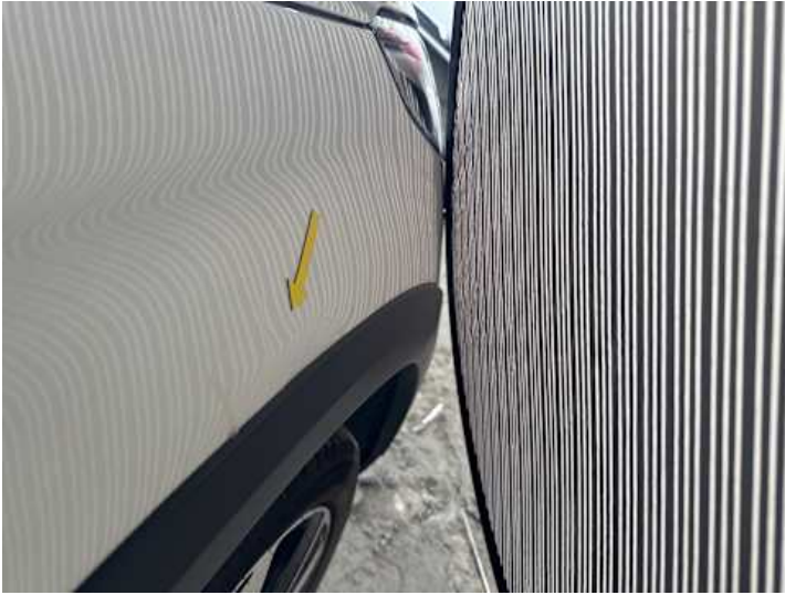
Kotflügel vorne rechts (Verformung)
