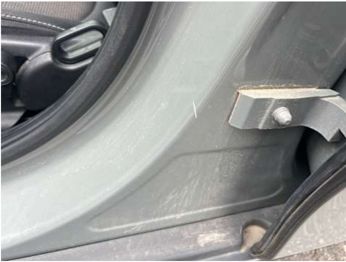
Schweller links (Kratzer)
