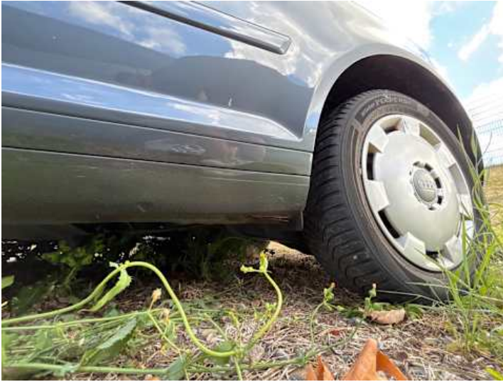
Schweller links (Rost)
