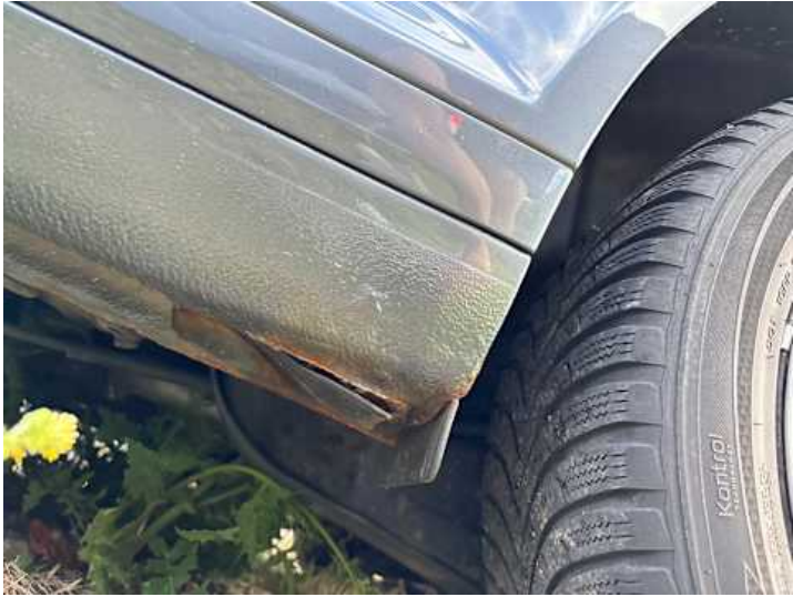
Schweller links (Rost)
