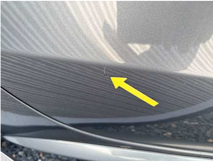
Türe hinten rechts (Delle, Kratzer)
