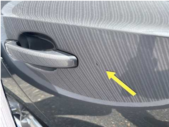
Türe hinten rechts (Delle, Kratzer)
