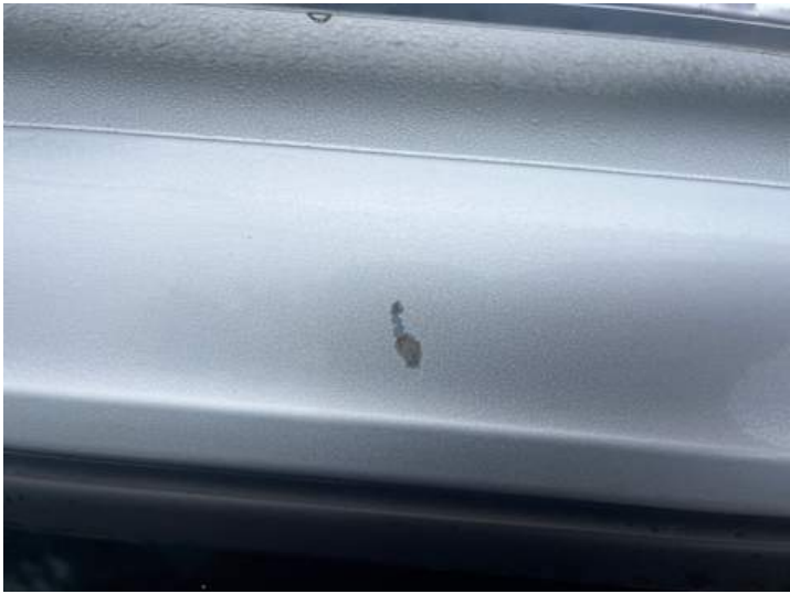
Seitenteil hinten links (Lackschaden, Rost)
