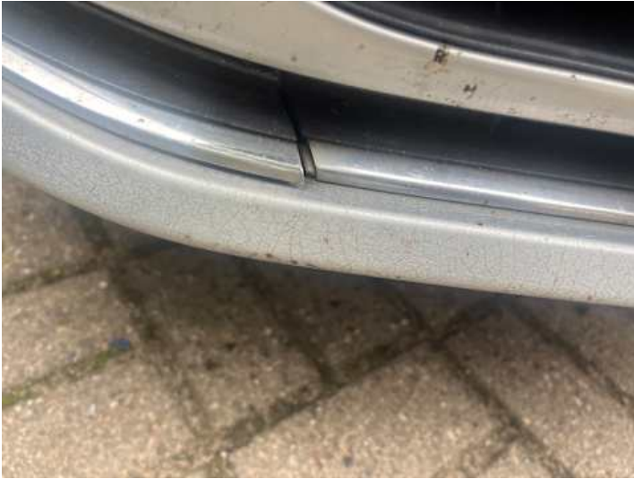
Stoßstange vorne (Verformung, Riss/Bruch)
