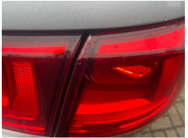
Rücklicht (rechts) (Kratzer, Riss/Bruch)
