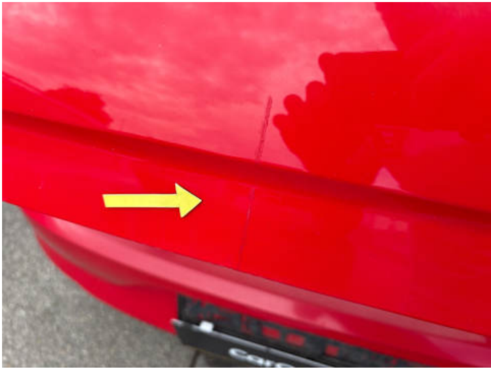
Heckklappe (Lackschaden, Kratzer, Unsachgemäß instand gesetzt)
