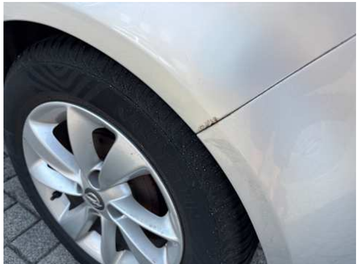
Seitenteil hinten links (Lackschaden, Rost)
