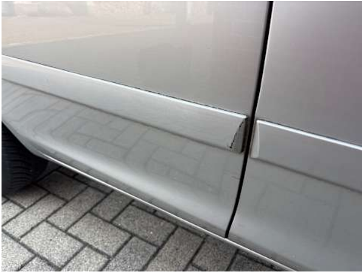
Türe hinten rechts (Kratzer, Lackschaden)
