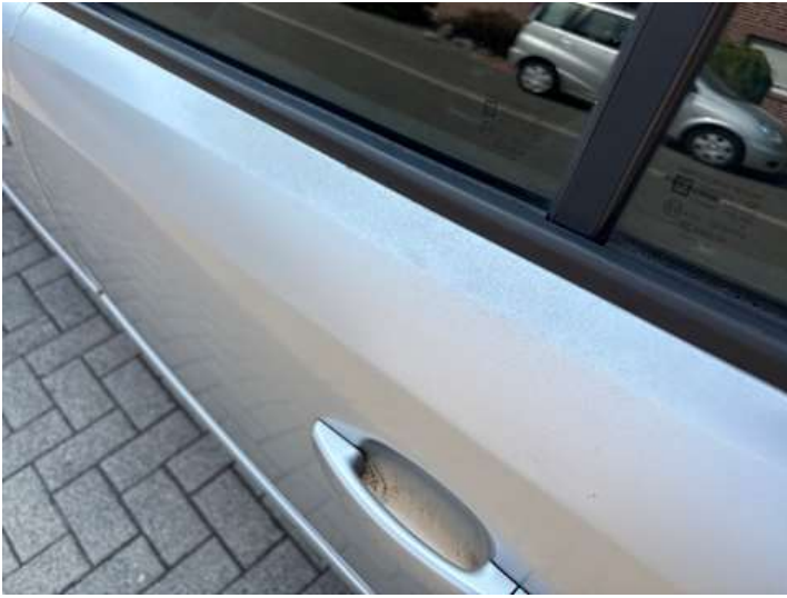
Türe hinten links (Lackschaden)
