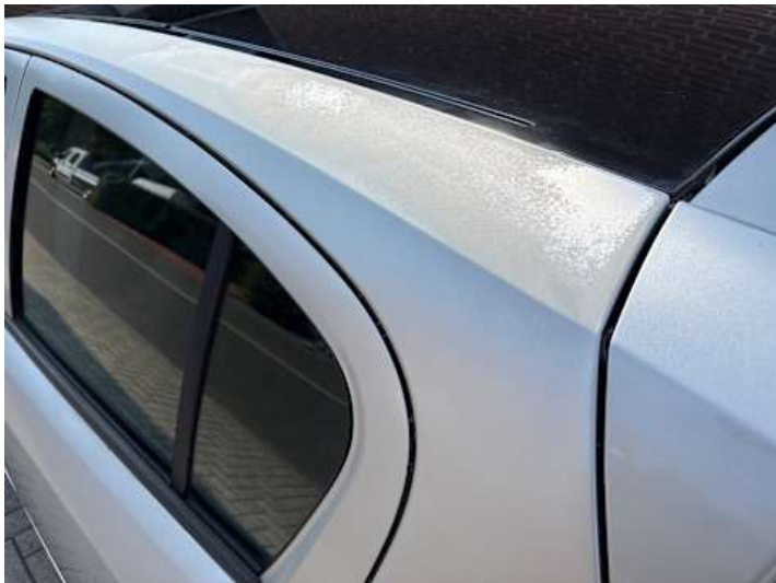
Seitenteil hinten links (Lackschaden)
