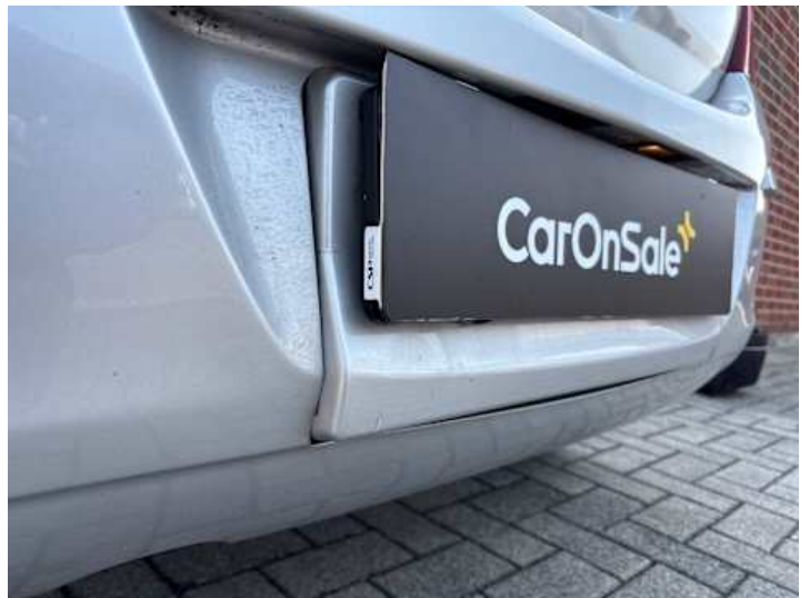
Stoßstange hinten (Spaltmaße ungenau, Verformung)
