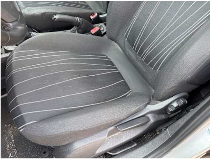
Innenraum (Verschleiß, Verschmutzung, Brandloch)
