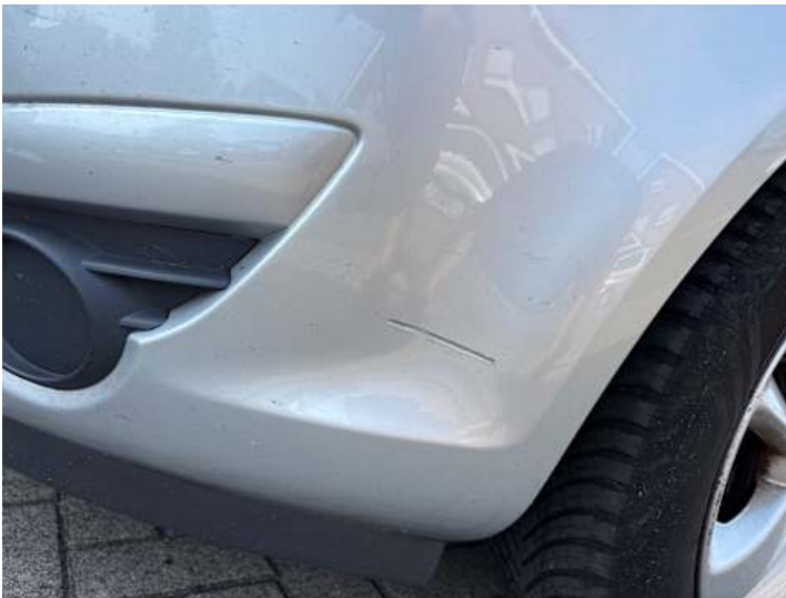
Stoßstange vorne (Kratzer, Lackschaden)
