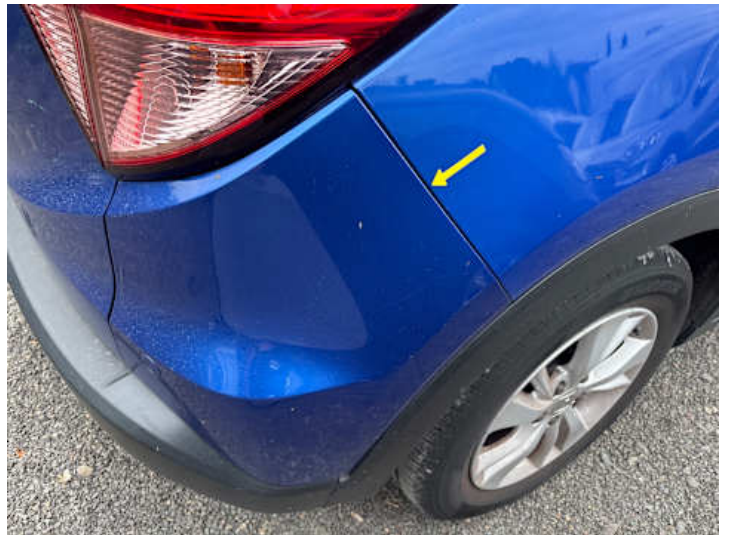
Stoßstange hinten (Unsachgemäß instand gesetzt, Spaltmaße ungenau)
