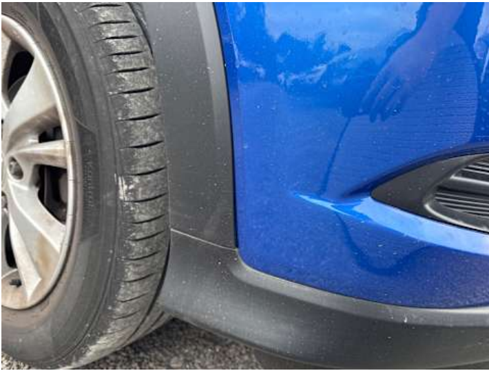
Kotflügel vorne rechts (Spaltmaße ungenau)
