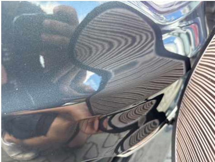
Stoßstange vorne (Verformung)
