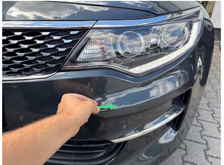
Stoßstange vorne (Verformung)
