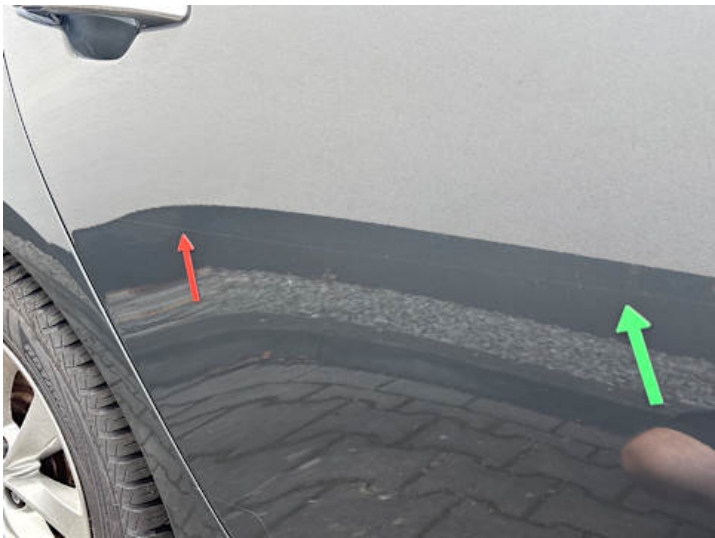
Türe hinten rechts (Kratzer)
