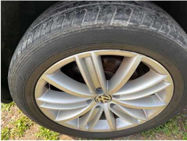
Rad (vehicle.damage-label.porous, Kratzer)
