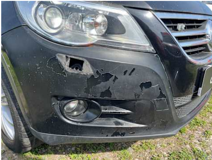
Stoßstange vorne (Lackschaden, Riss/Bruch)
