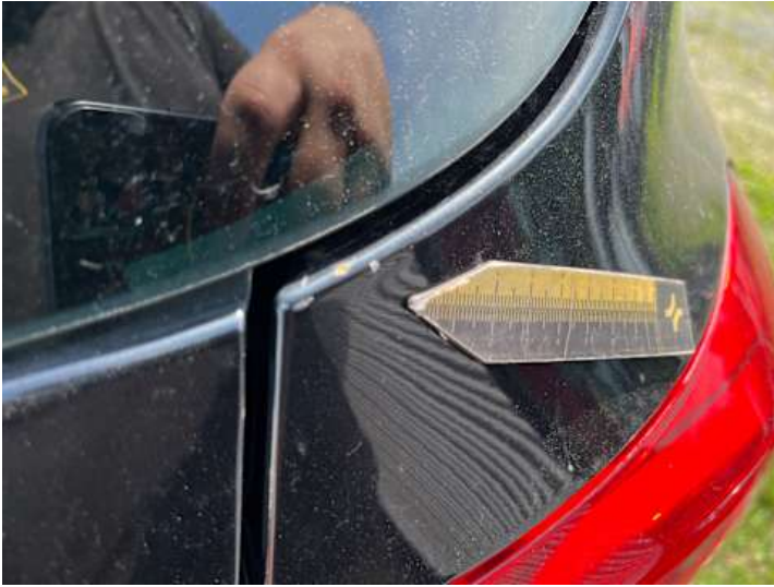
Seitenteil hinten rechts (Kratzer, Rost)
