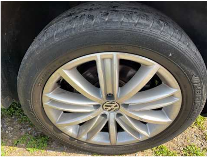
Rad (vehicle.damage-label.porous, Kratzer)
