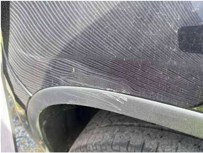
Seitenteil hinten rechts (Verformung, Kratzer)
