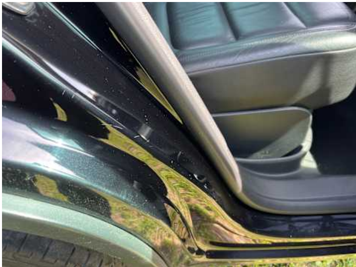
Schweller rechts (Kratzer)
