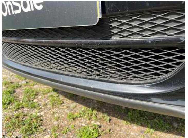
Stoßstange vorne (Riss/Bruch, Kratzer)
