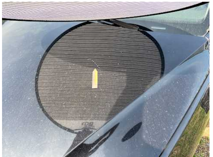
Motorhaube (Kratzer, Delle)
