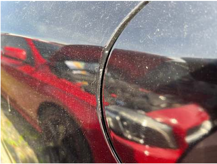
Seitenteil hinten rechts (Verformung, Kratzer)
