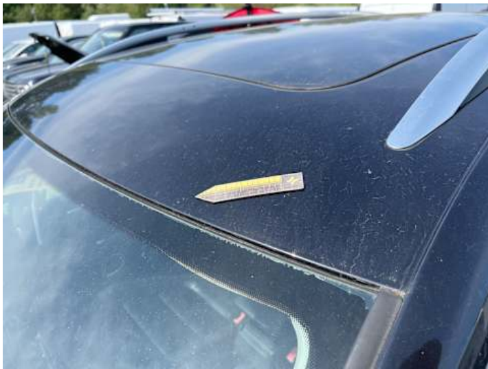
Dach (Steinschlag, Rost)
