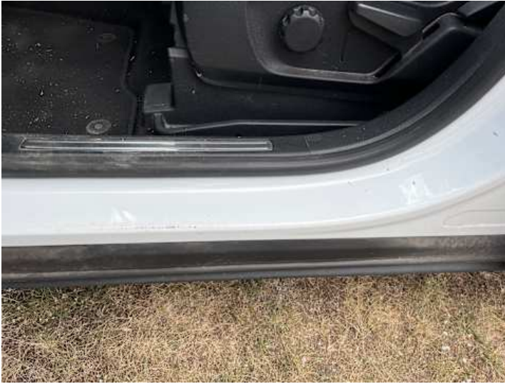
Schweller links (Kratzer, Delle)
