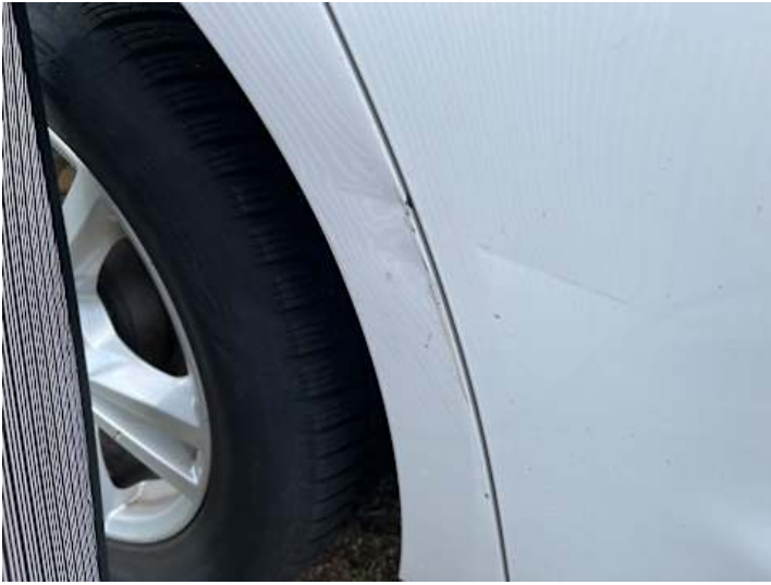
Seitenteil hinten rechts (Delle, Kratzer)
