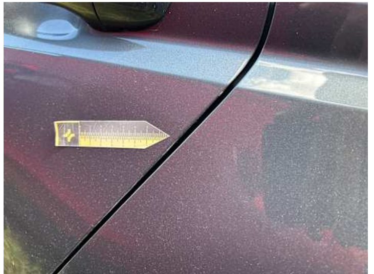
Seitenteil hinten links (Kratzer)
