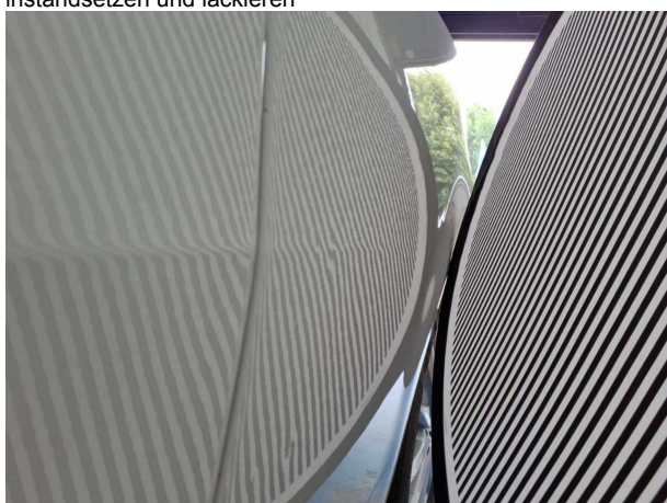
Beschädigung #6: Seitenwand links: Seitenwand - Delle(n) - instandsetzen und lackieren
