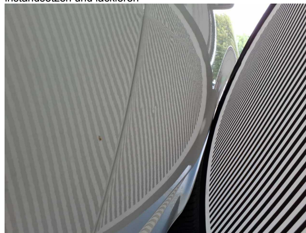
Beschädigung #6: Seitenwand links: Seitenwand - Delle(n) - instandsetzen und lackieren
