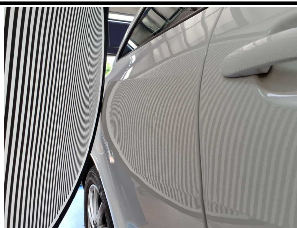
Beschädigung #5: Seitenwand rechts: Seitenwand - Delle(n) - instandsetzen und lackieren
