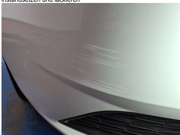
Beschädigung #7: Stossfänger vorn: Stossfänger vorn - Kratzer - instandsetzen und lackieren
