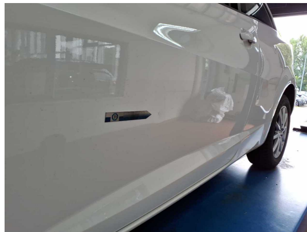
Beschädigung #2: Tür vorn links: Tür - Delle(n) - sanft instandsetzen
