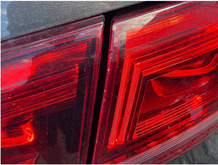
Rücklicht (rechts) (Riss/Bruch)
