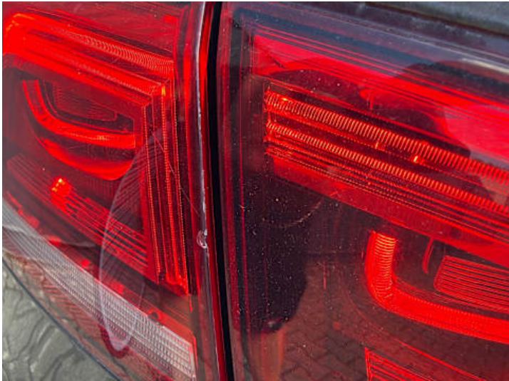
Rücklicht (links) (Riss/Bruch)
