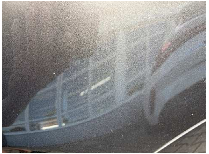
Kotflügel vorne rechts (Kratzer, Lackschaden)
