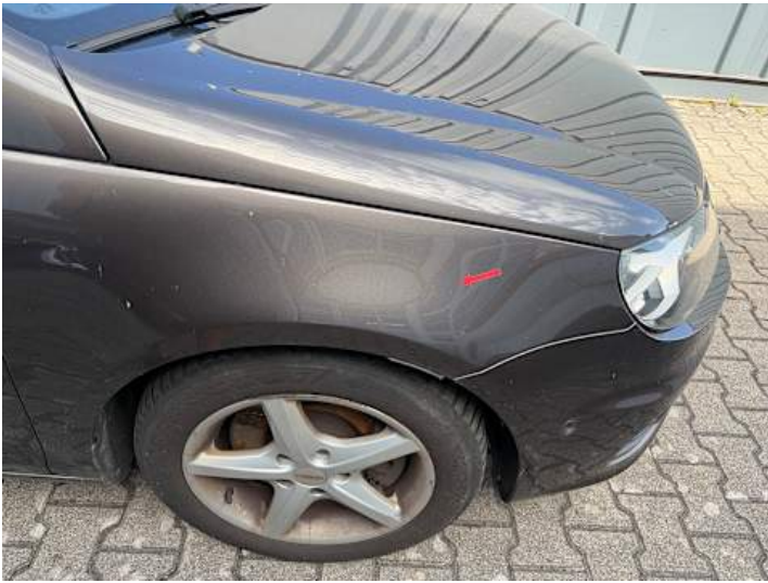
Kotflügel vorne rechts (Kratzer, Lackschaden)
