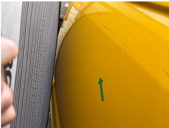
Türe hinten rechts (Kratzer, Delle)
