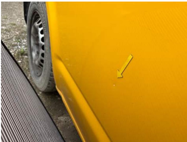
Fahrtür (Kratzer, Delle)
