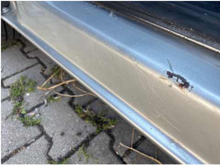
Schweller links (Rost)
