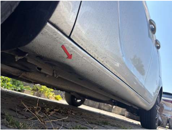
Schweller links (Verformung)
