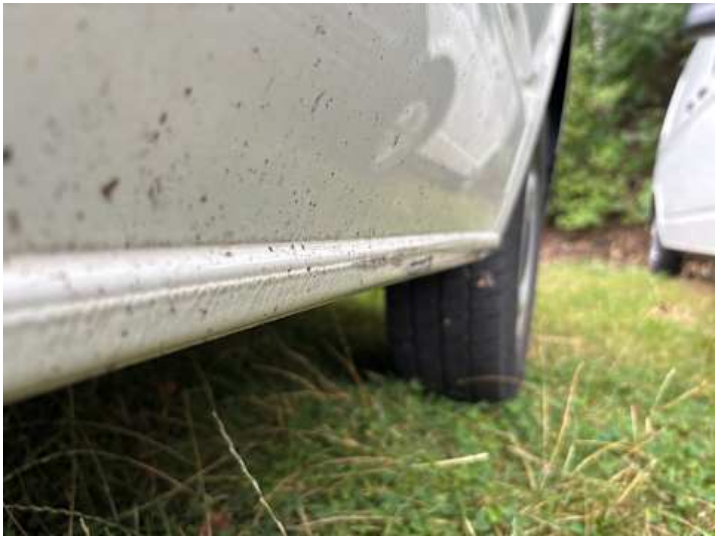
Schweller links (Verformung, Lackschaden, Kratzer)
