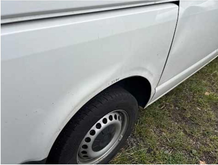
Seitenteil hinten rechts (Kratzer, Lackschaden, Verformung)
