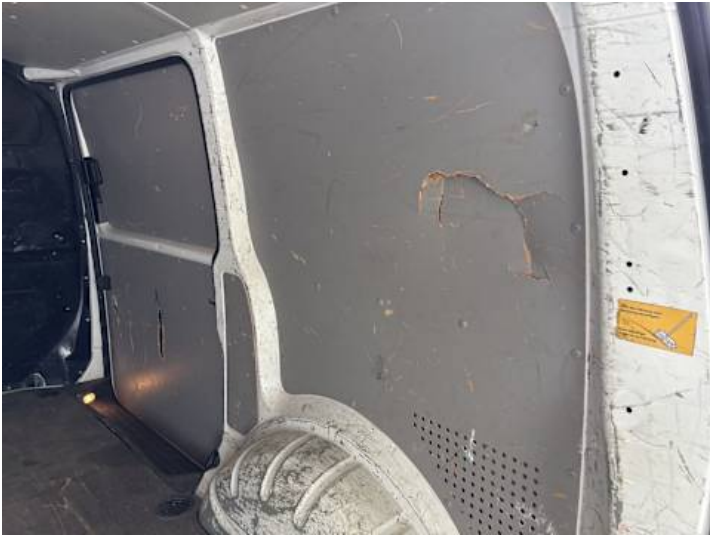
Innenraum (Riss/Bruch, Verschleiß)
