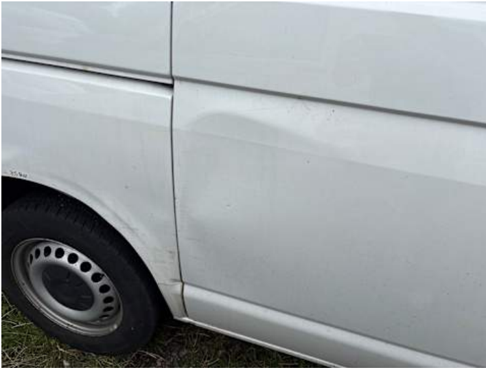
Türe hinten rechts (Verformung, Lackschaden)
