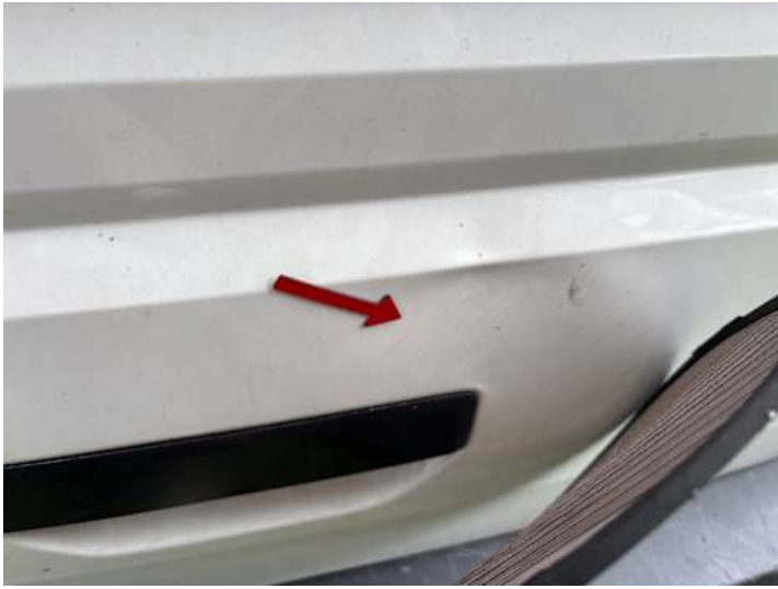
Heckklappe (Delle, Verformung)
