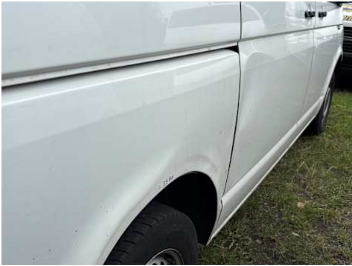
Seitenteil hinten rechts (Kratzer, Lackschaden, Verformung)
