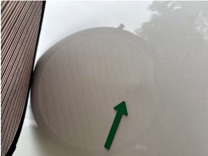
Seitenteil hinten links (Delle, Verformung)
