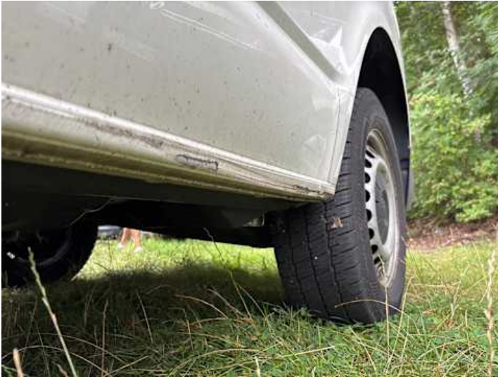
Schweller links (Verformung, Lackschaden, Kratzer)
