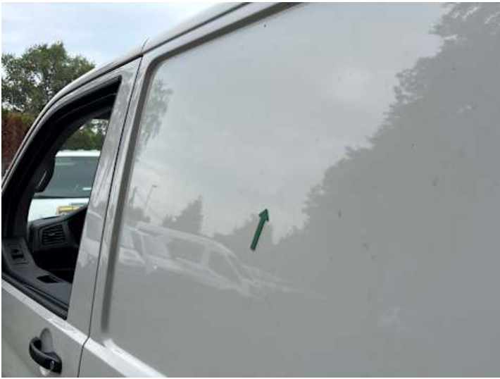
Seitenteil hinten links (Delle, Verformung)
