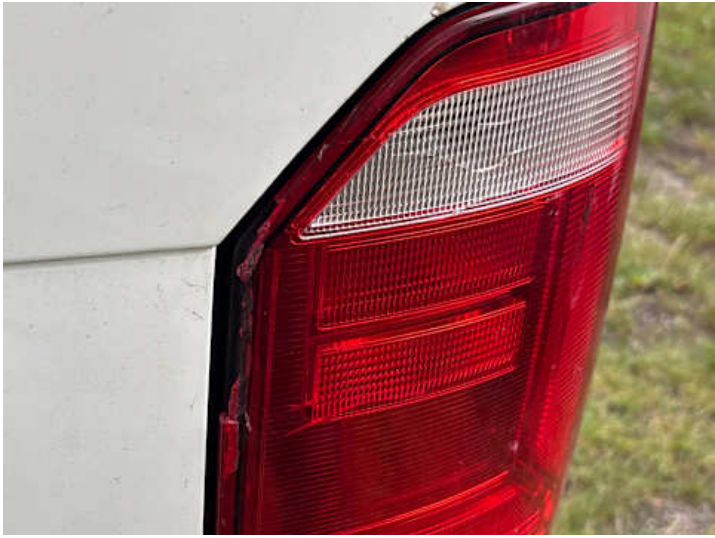
Rücklicht (rechts) (Kratzer, Riss/Bruch)
