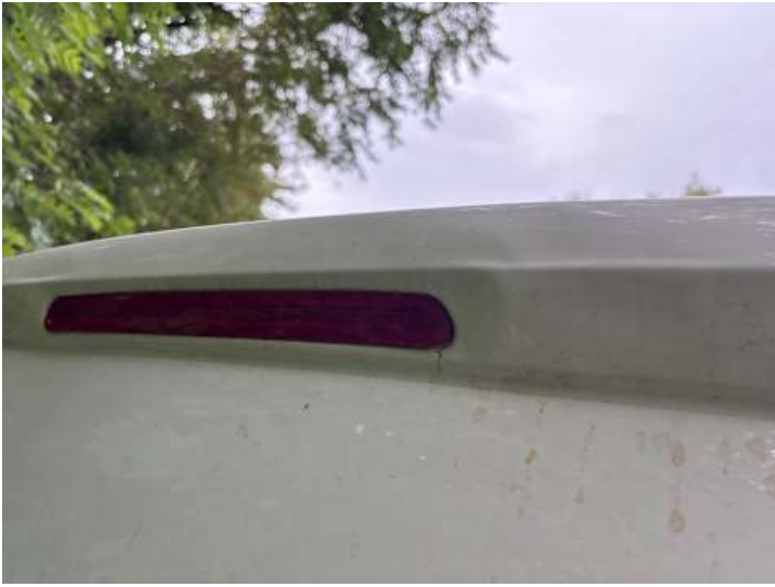
Heckklappe (Delle, Verformung)
