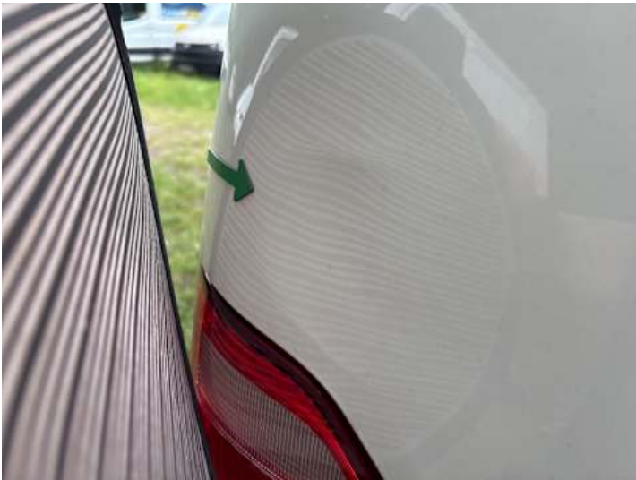
Heckklappe (Delle, Verformung)
