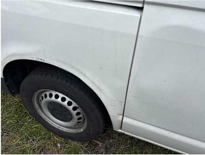
Seitenteil hinten rechts (Kratzer, Lackschaden, Verformung)
