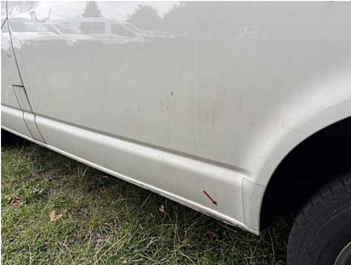
Seitenteil hinten links (Verformung, Lackschaden, Kratzer)
