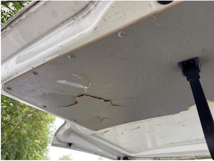
Innenraum (Riss/Bruch, Verschleiß)
