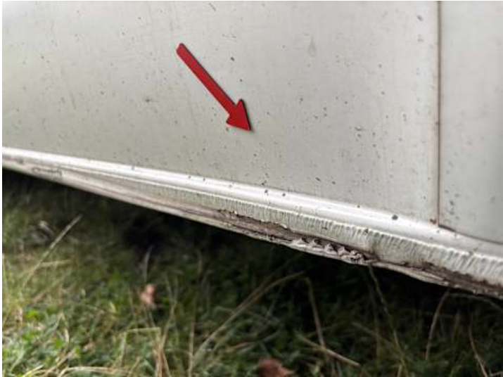
Seitenteil hinten links (Verformung, Lackschaden, Kratzer)
