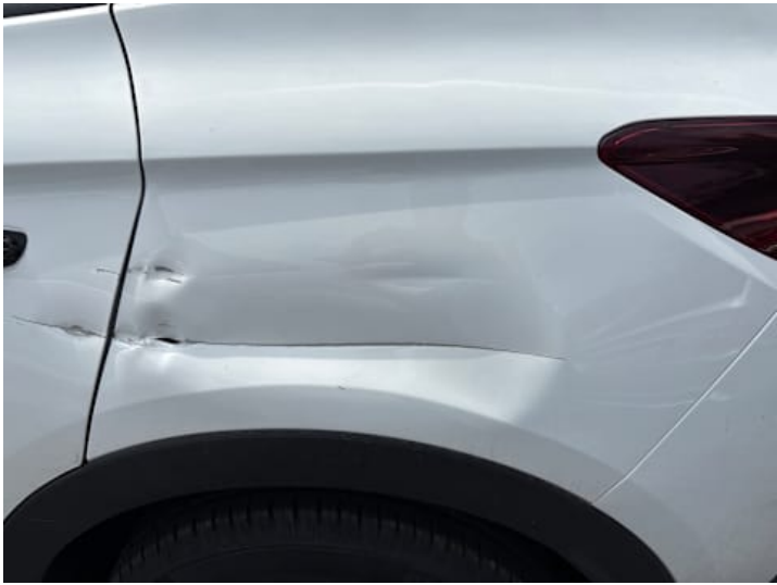
Seitenteil hinten links (Kratzer, Riss/Bruch, Verformung)
