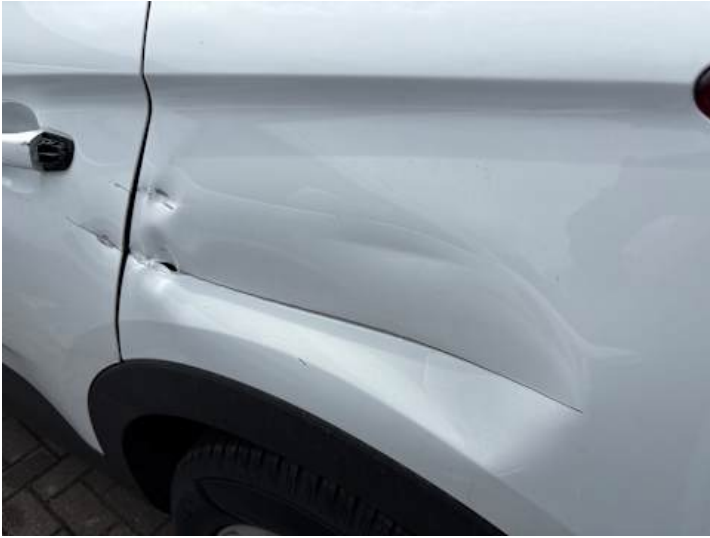
Seitenteil hinten links (Kratzer, Riss/Bruch, Verformung)
