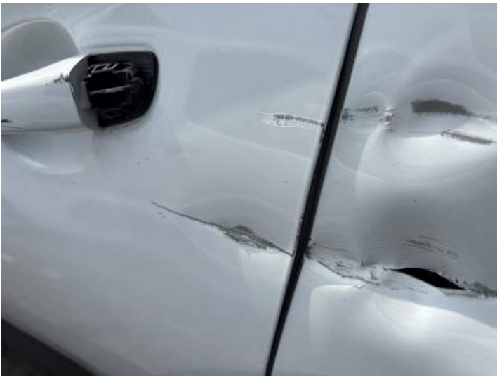
Türe hinten links (Kratzer, Verformung)
