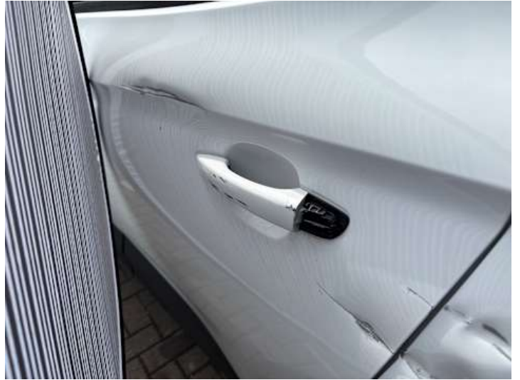
Türe hinten links (Kratzer, Verformung)
