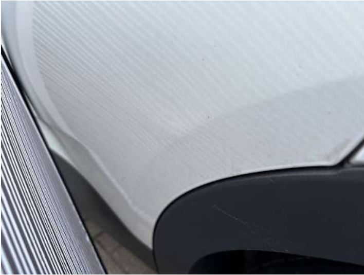
Türe hinten links (Kratzer, Verformung)
