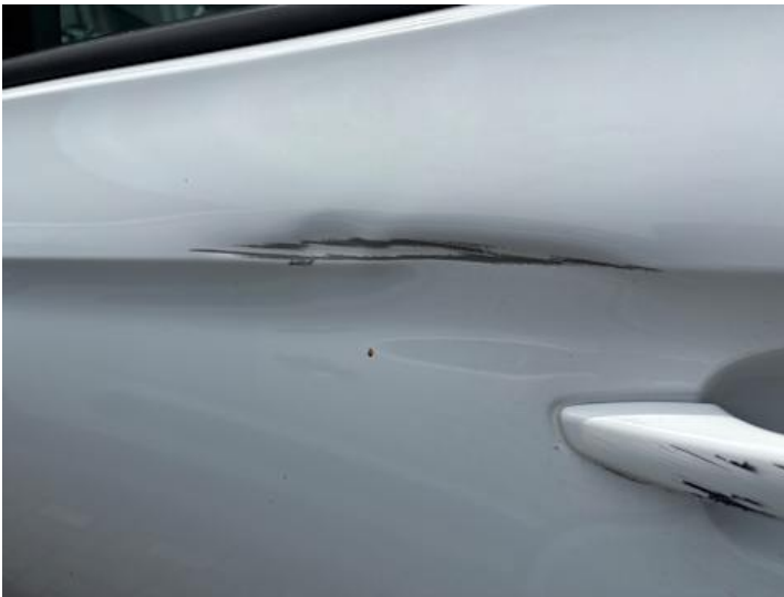
Türe hinten links (Kratzer, Verformung)
