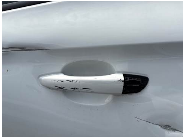
Türe hinten links (Kratzer, Verformung)
