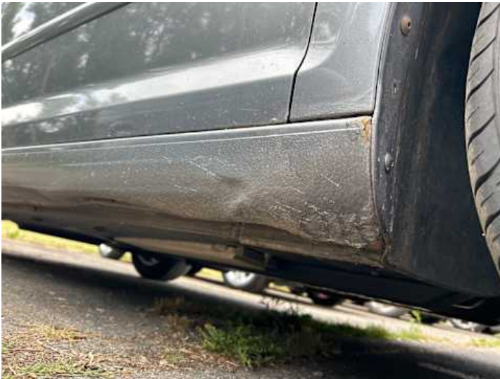
Schweller rechts (Rost, Verformung)
