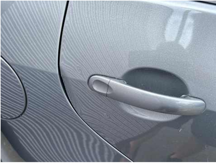
Türe hinten rechts (Delle, Verformung)
