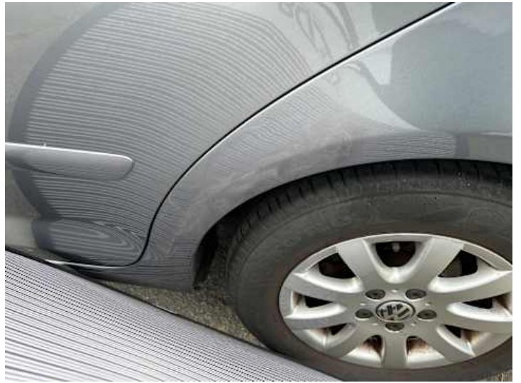
Seitenteil hinten links (Unsachgemäß instand gesetzt)
