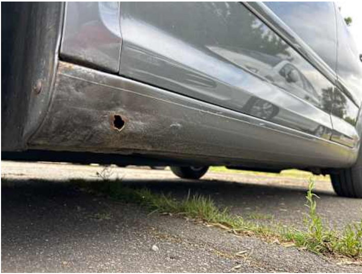
Schweller links (Rost)
