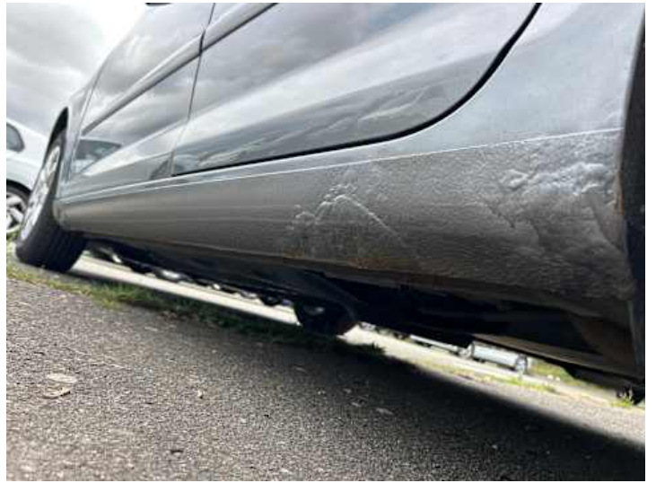
Schweller links (Rost)
