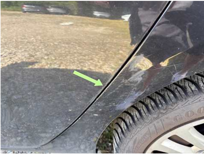
Türe hinten links (Kratzer, Lackschaden)
