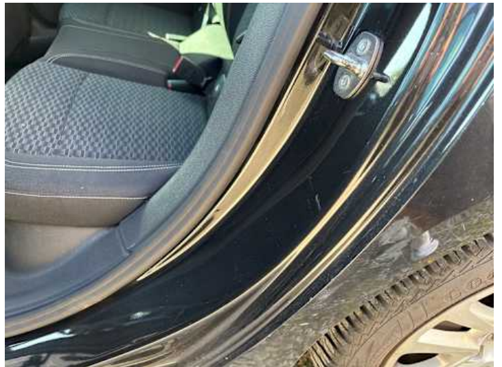
Türe hinten links (Kratzer, Lackschaden)
