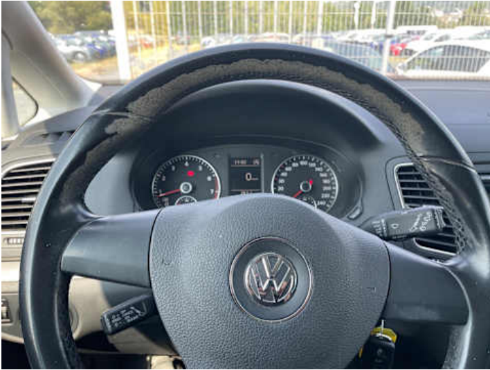
Innenraum (Diverse Schäden)
