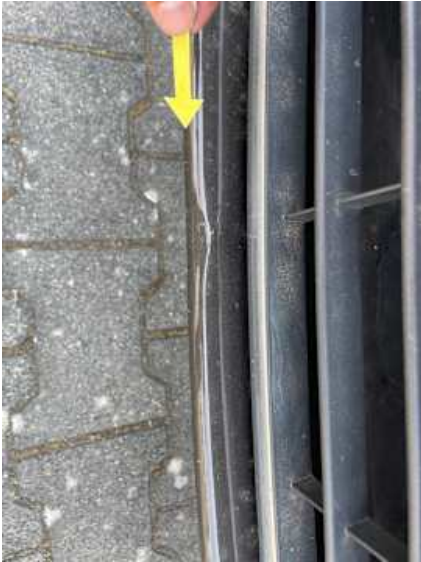
Stoßstange vorne (Verformung)
