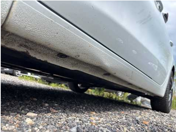
Schweller links (Verformung)
