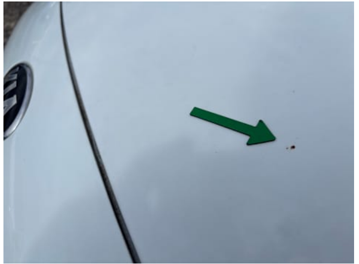
Motorhaube (Steinschlag, Rost)
