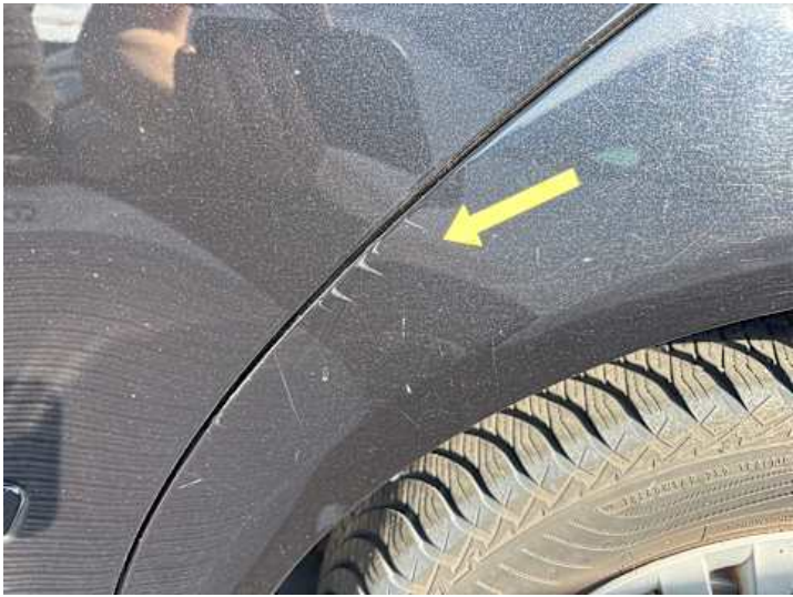
Seitenteil hinten links (Kratzer)
