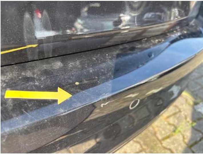
Stoßstange hinten (Verformung, Lackschaden)
