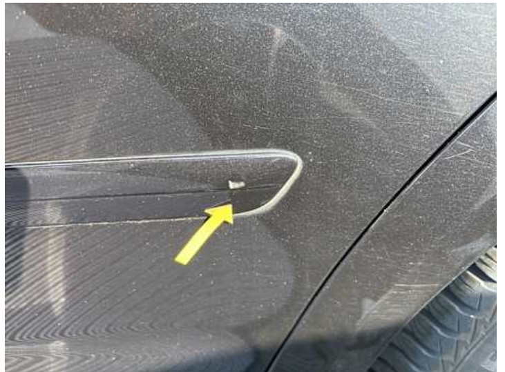
Türe hinten links (Lackschaden)
