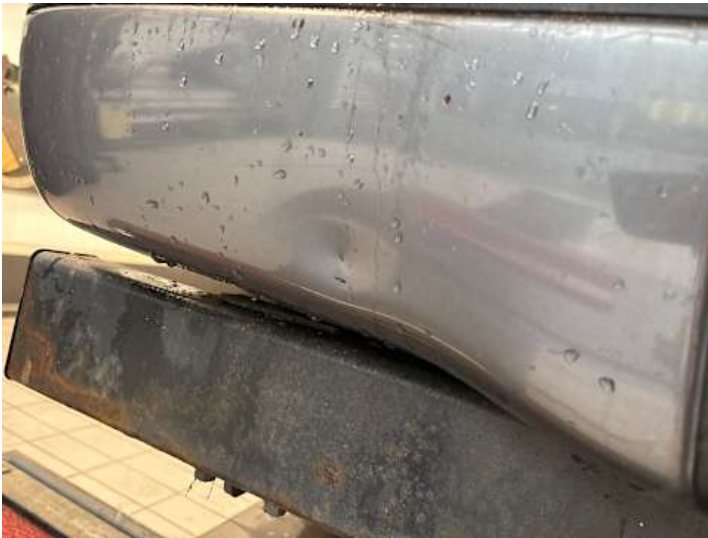
Stoßstange hinten (Verformung)
