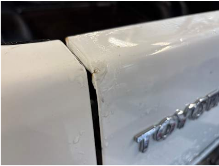
Heckklappe (Rost, Unsachgemäß instand gesetzt)
