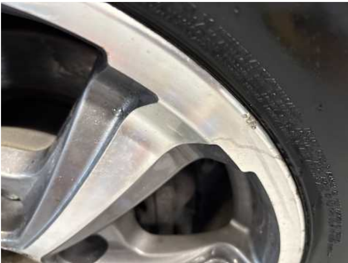
Rad (Kerben, Rost)
