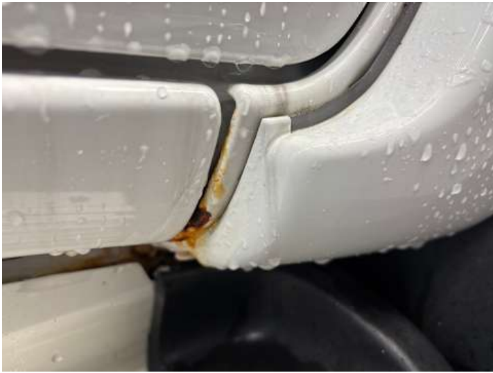
Kotflügel vorne rechts (Rost)
