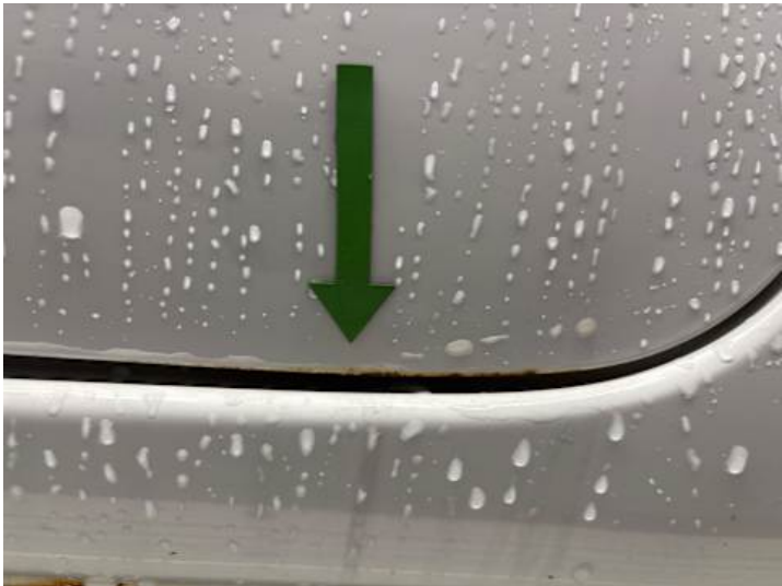
Türe hinten links (Rost)
