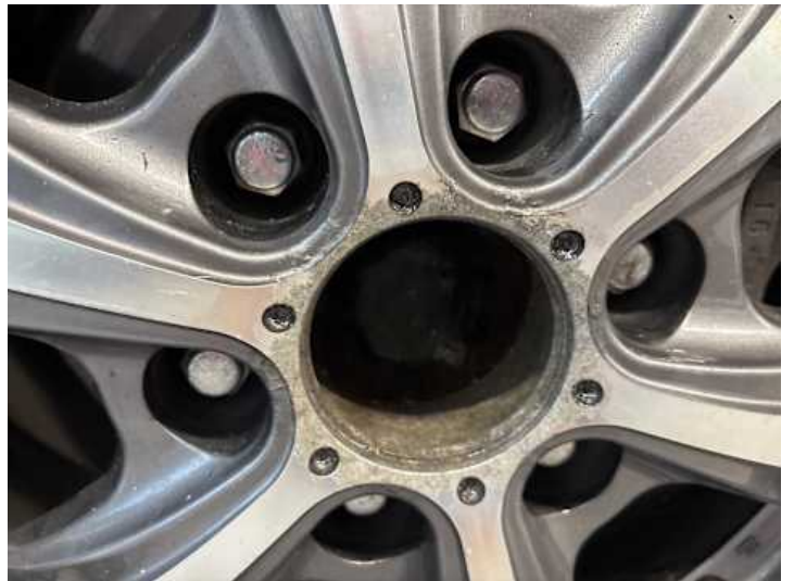
Rad (Kerben, Rost)
