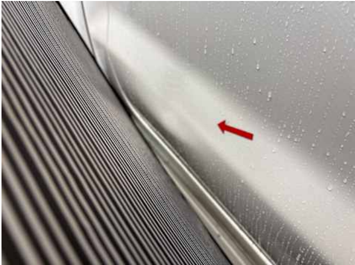
Türe hinten rechts (Verformung)
