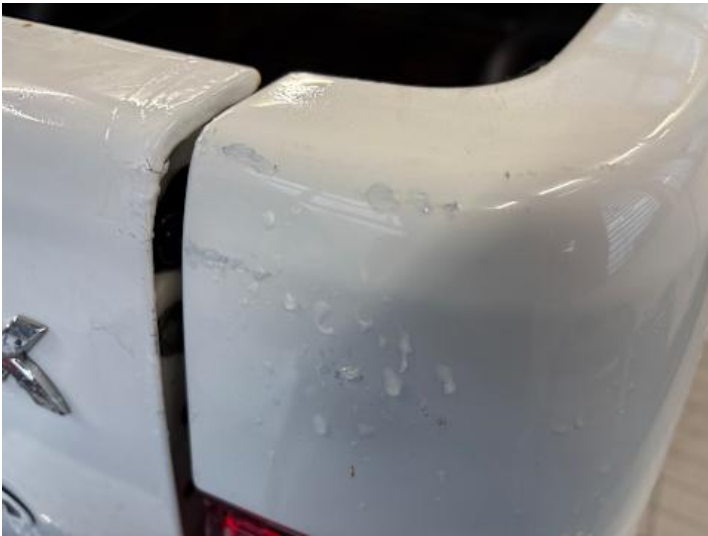
Seitenteil hinten rechts (Unsachgemäß instand gesetzt)
