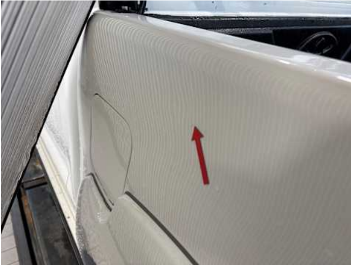
Seitenteil hinten links (Delle)
