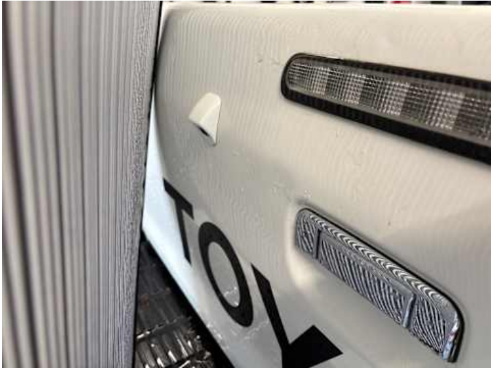
Heckklappe (Verformung, Lackschaden, Delle)
