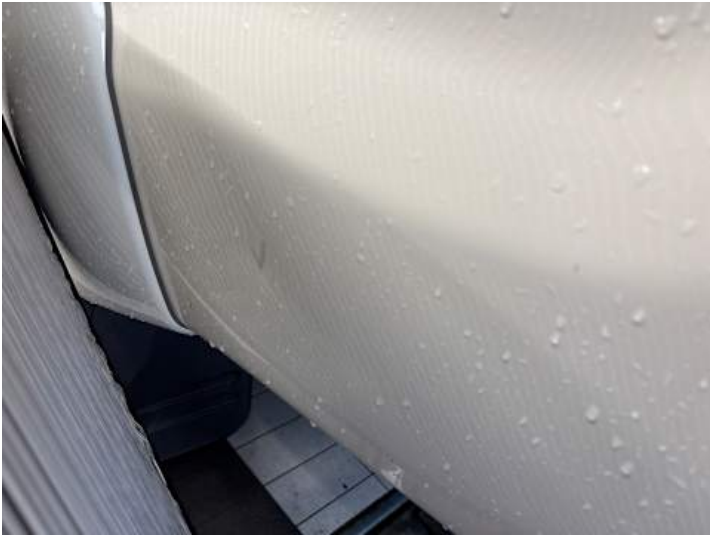
Seitenteil hinten links (Delle, Lackschaden)
