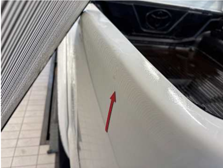
Seitenteil hinten links (Delle)
