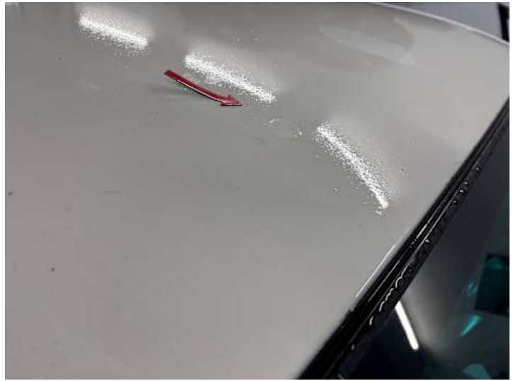
Dach (Unsachgemäß instand gesetzt)
