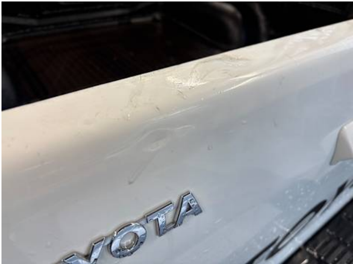
Heckklappe (Verformung, Lackschaden, Delle)
