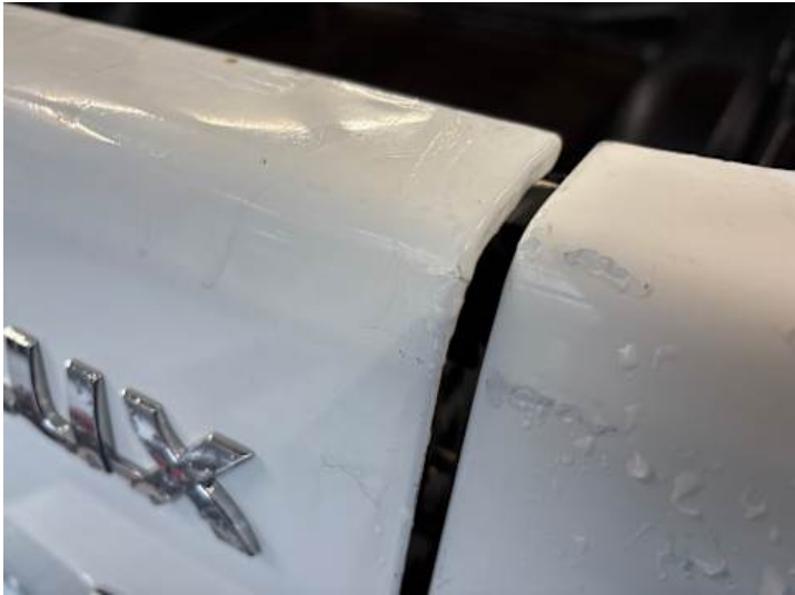
Heckklappe (Rost, Unsachgemäß instand gesetzt)
