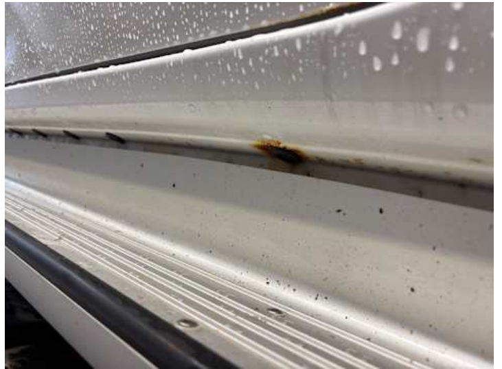
Schweller links (Rost)
