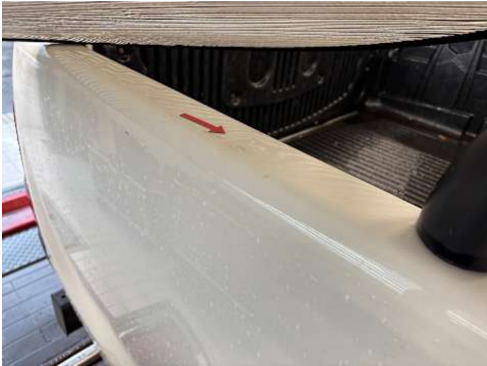
Seitenteil hinten rechts (Delle)
