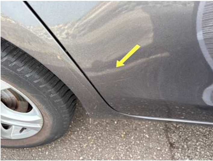
Türe hinten rechts (Kratzer)
