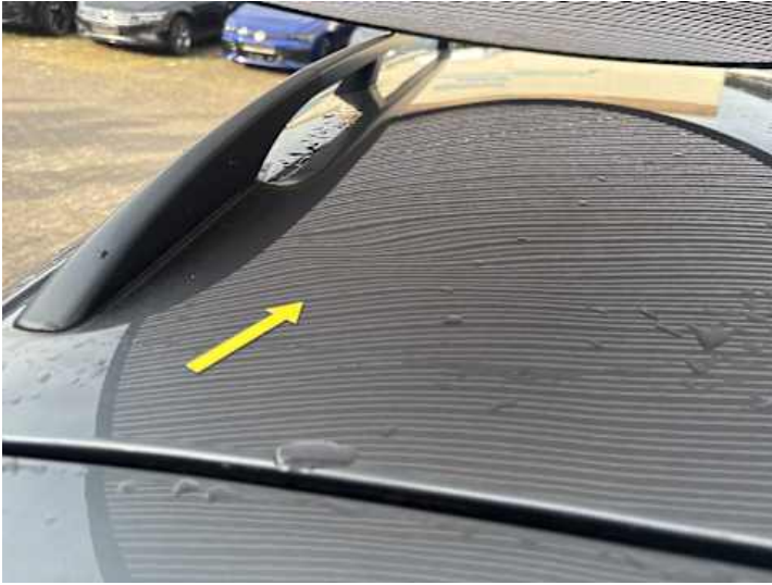
Dach (Verformung, Delle)
