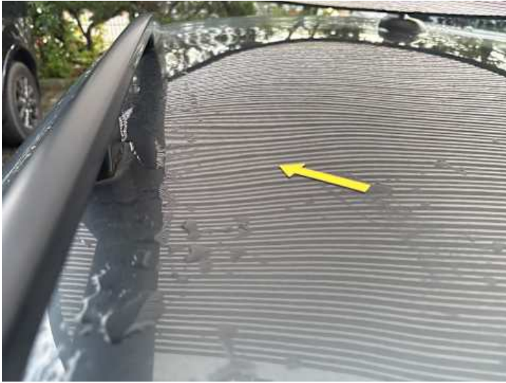
Dach (Verformung, Delle)
