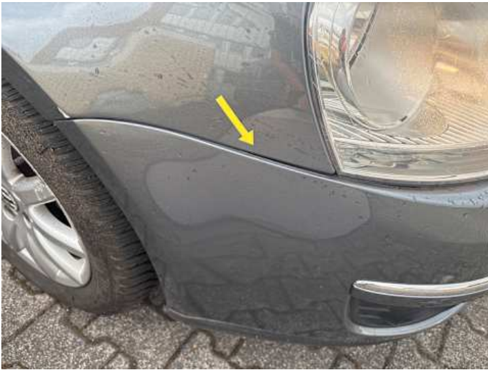
Stoßstange vorne (Unsachgemäß instand gesetzt, Spaltmaße ungenau)
