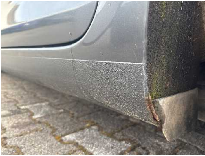
Schweller links (Rost)
