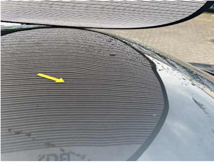
Dach (Verformung, Delle)
