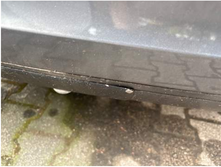
Stoßstange hinten (Spaltmaße ungenau)
