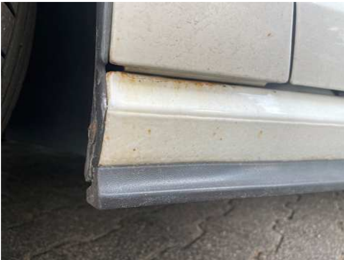
Schweller links (Rost)
