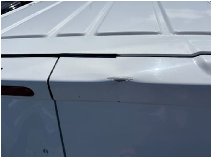
Heckklappe (Delle, Lackschaden, Kratzer, Verformung)
