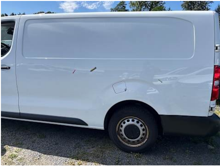
Seitenteil hinten links (Kratzer, Delle)
