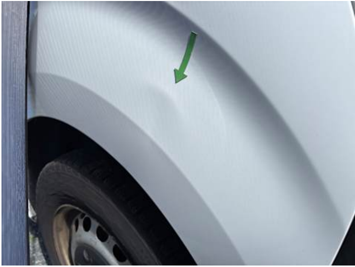
Kotflügel vorne rechts (Delle, Kratzer)
