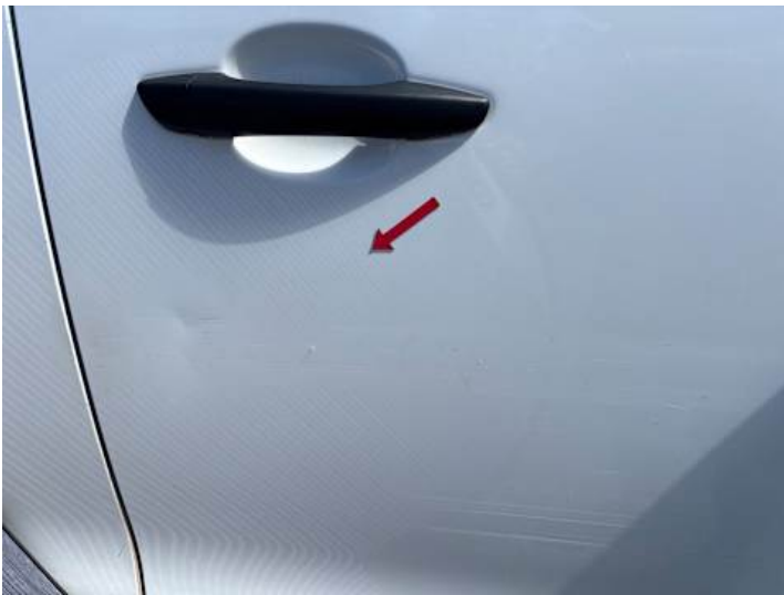
Beifahrertür (Kratzer, Lackschaden, Delle)
