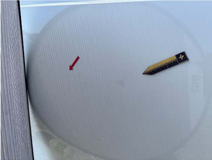
Seitenteil hinten links (Kratzer, Delle)
