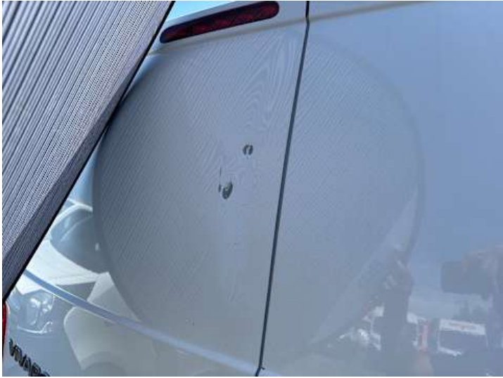
Heckklappe (Delle, Lackschaden, Kratzer, Verformung)
