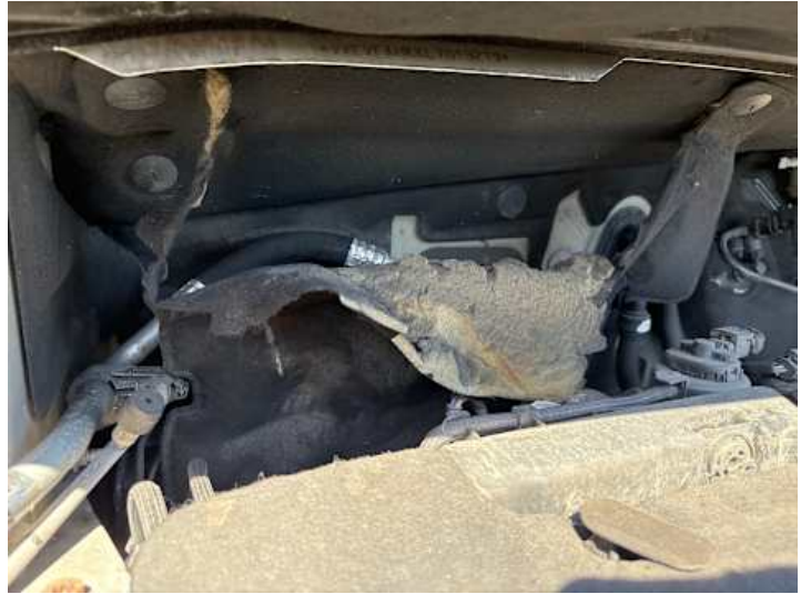
Motorhaube (Anderer Schaden): Dämmung beschädigt
