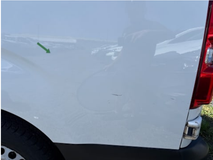
Seitenteil hinten links (Kratzer, Delle)
