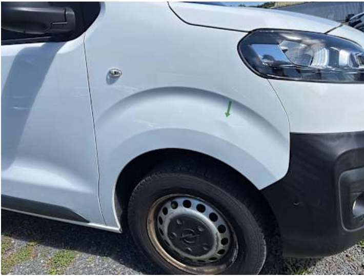
Kotflügel vorne rechts (Delle, Kratzer)
