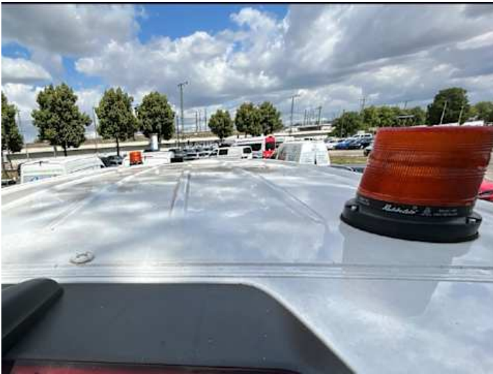
Dach (Anderer Schaden): Rundumleuchten montiert
