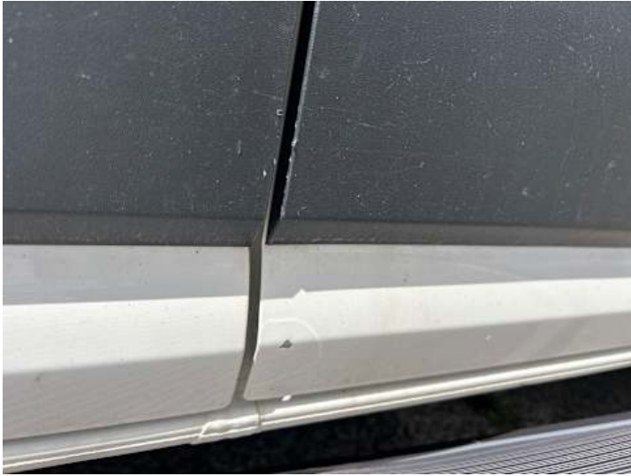
Beifahrtür (Delle, Kratzer, Lackschaden)
