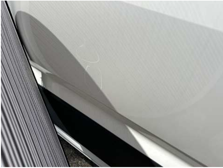
Türe hinten rechts (Delle)
