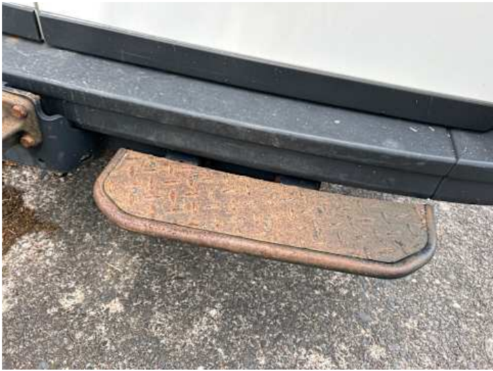
Stoßstange hinten (Rost)
