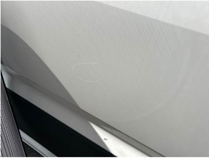
Türe hinten rechts (Delle)
