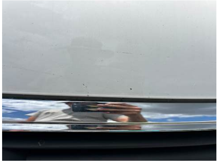
Motorhaube (Steinschlag, Rost)
