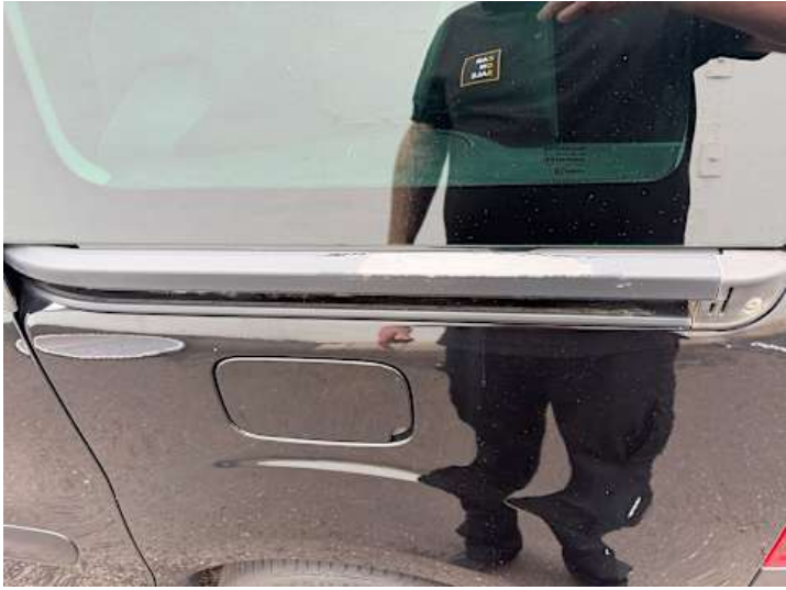
Seitenteil hinten links (Lackschaden)
