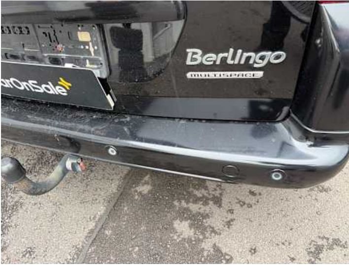
Stoßstange hinten (Kratzer, Lackschaden)
