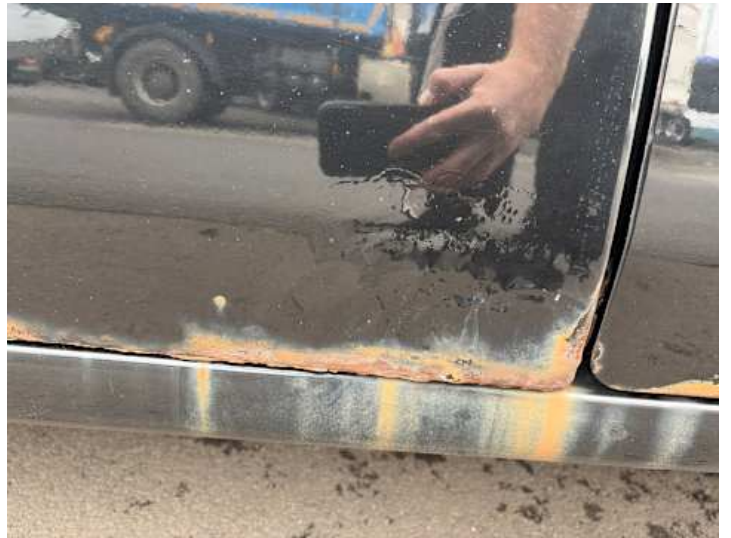
Türe hinten rechts (Rost, Lackschaden)
