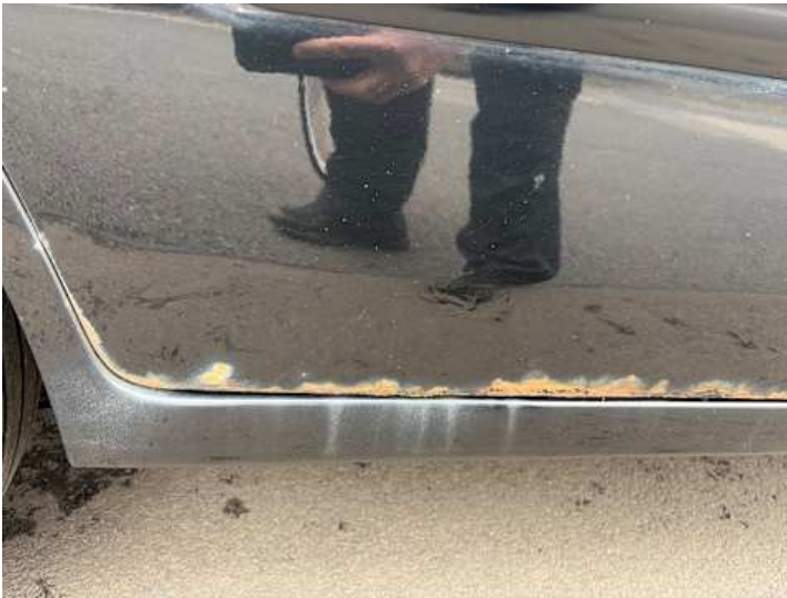
Türe hinten rechts (Rost, Lackschaden)
