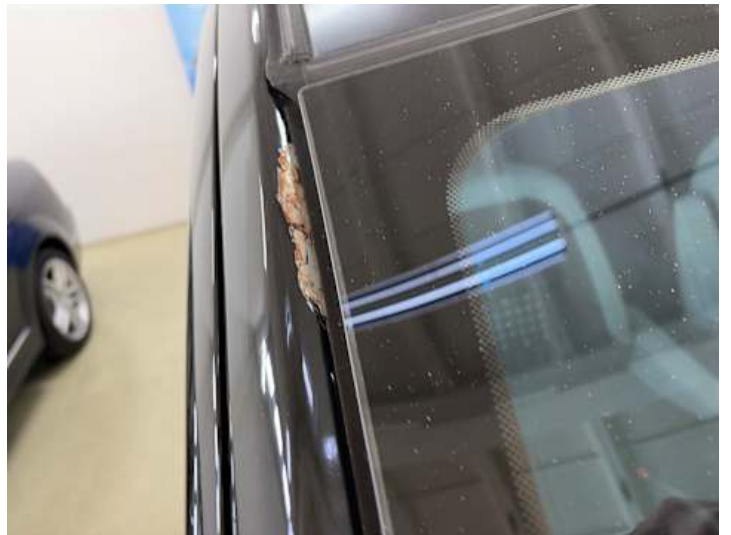
Dach (Steinschlag, Lackschaden)
