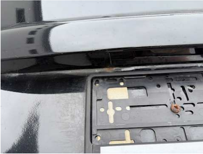
Heckklappe (Rost, Lackschaden)
