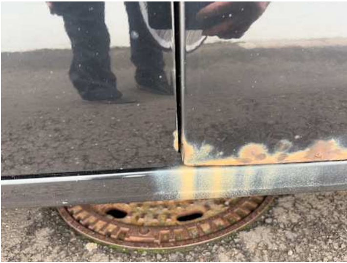
Fahrtür (Rost, Lackschaden)
