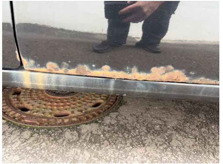
Türe hinten links (Rost, Lackschaden)
