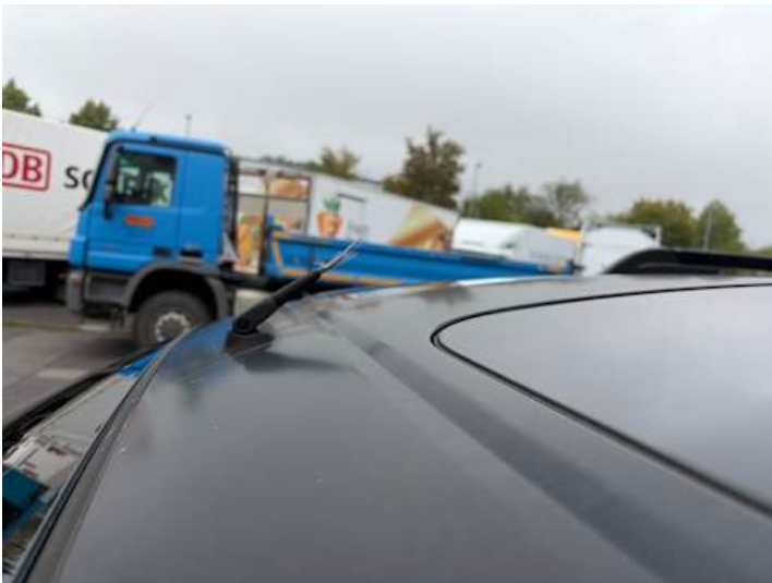
Dach (Anderer Schaden): Antenne defekt
