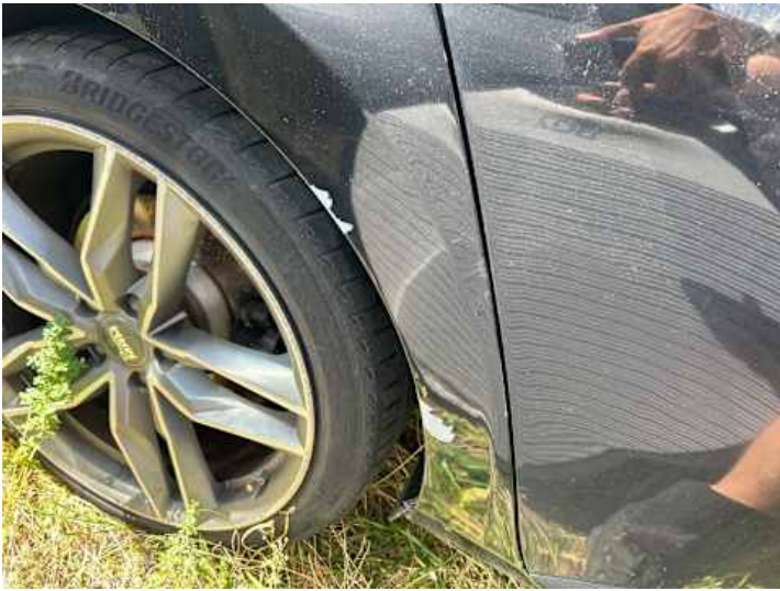
Seitenteil hinten rechts (Unsachgemäß instand gesetzt, Rost)
