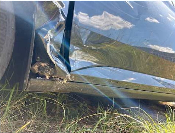
Schweller links (Verformung, Riss/Bruch)
