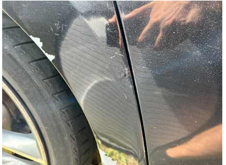
Seitenteil hinten rechts (Unsachgemäß instand gesetzt, Rost)
