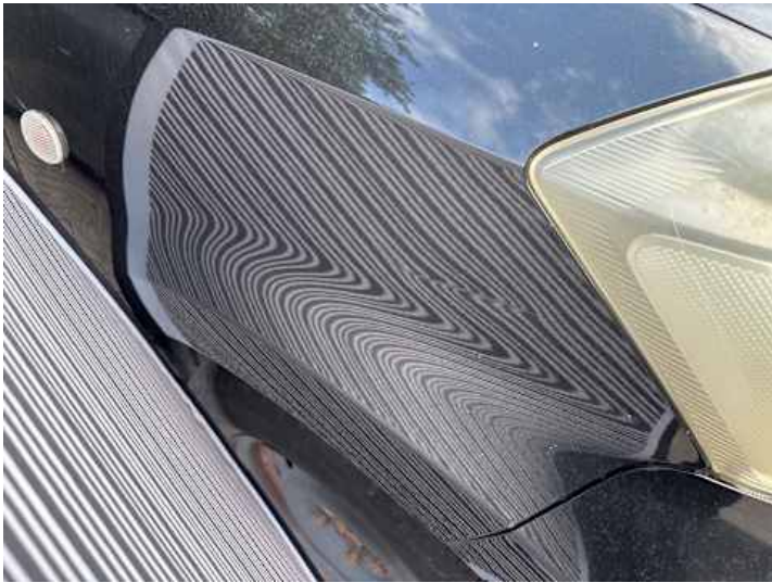
Kotflügel vorne rechts (Delle)
