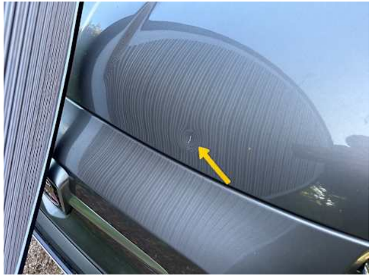
Motorhaube (Kratzer, Delle)
