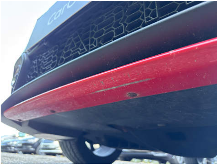
Stoßstange vorne (Kratzer, Lackschaden)
