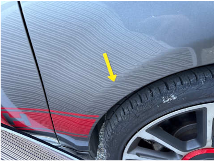
Kotflügel vorne rechts (Delle)
