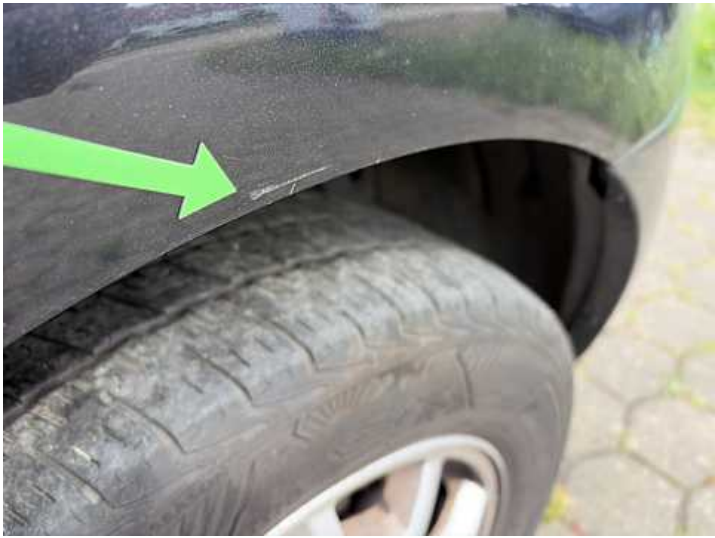
Kotflügel vorne rechts (Kratzer)
