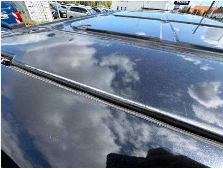
Dach (Lackschaden, Delle)
