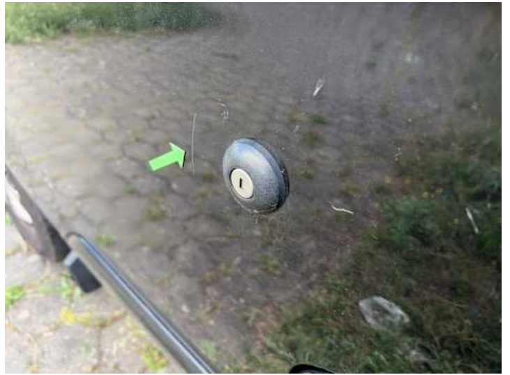
Fahrrertür (Kratzer, Ausgeblichen/Matt)
