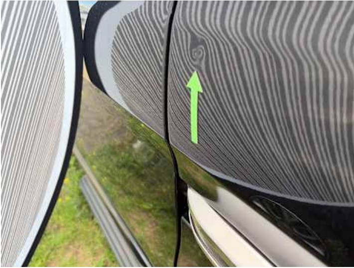
Seitenteil hinten links (Delle)
