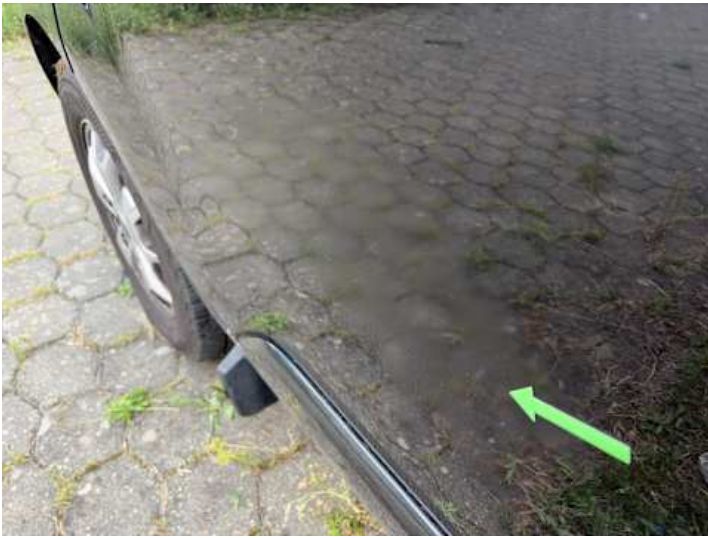
Fahrrertür (Kratzer, Ausgeblichen/Matt)
