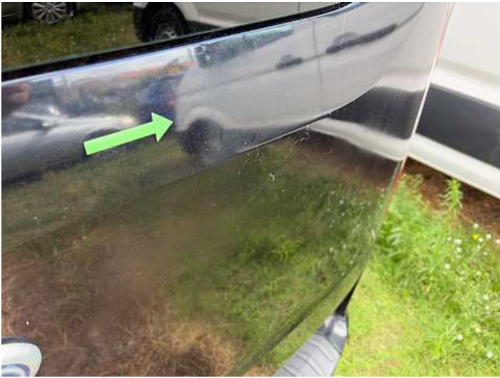
Heckklappe (Ausgeblichen/Matt, Lackschaden, Delle)
