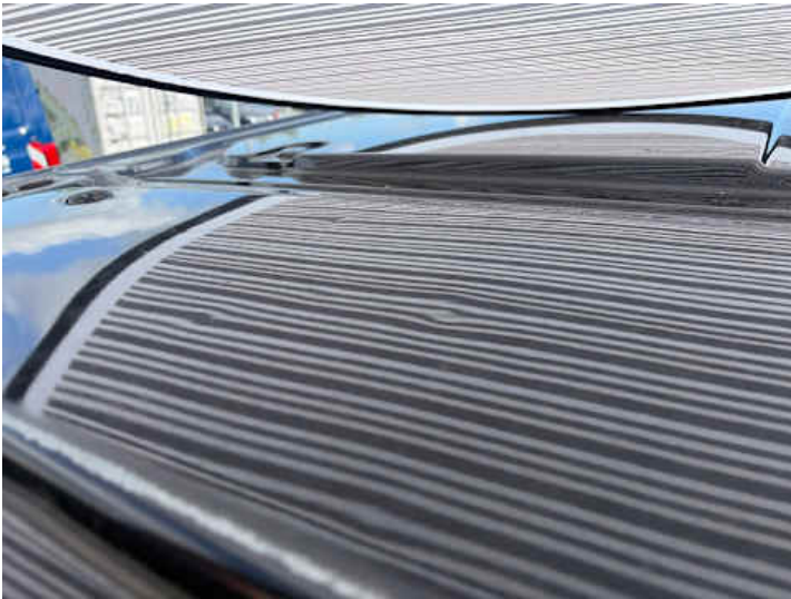
Dach (Lackschaden, Delle)
