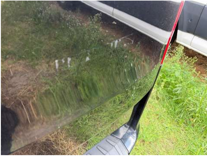
Heckklappe (Ausgeblichen/Matt, Lackschaden, Delle)
