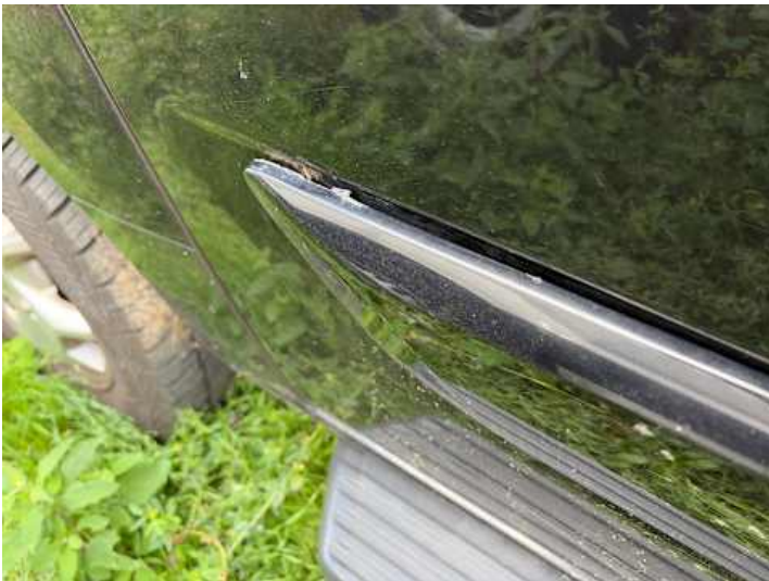
Türe hinten rechts (Kratzer, Anderer Schaden): Blende löst sich
