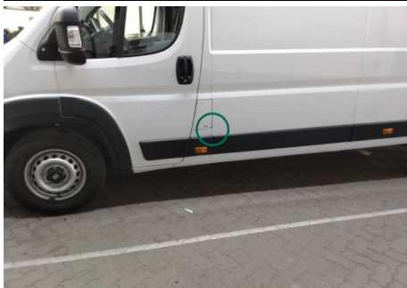
Dichtnaht / Vorne Links / Schlecht Repariert
