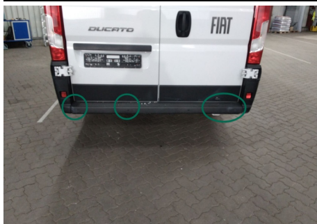
Stoßfänger / Hinten / Kratzer
