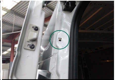
Abdeckung / Oben Rechts / Fehlt
