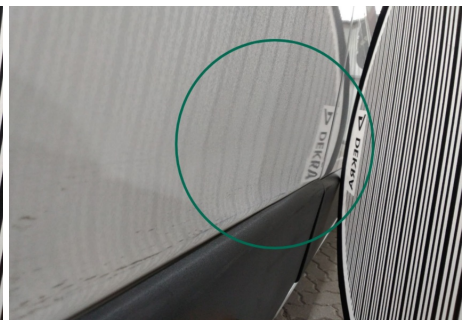
Seitenwand / Unten Hinten Rechts / Schlecht Repariert
