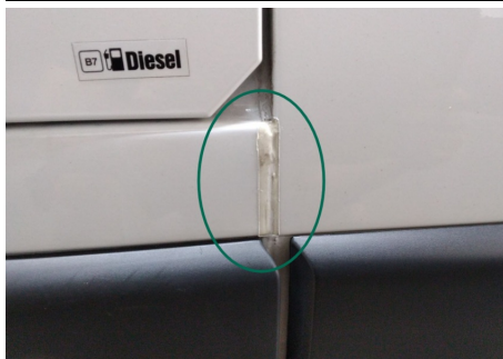
Dichtnaht / Vorne Links / Schlecht Repariert
