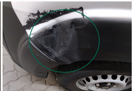
Kotflügelzierleiste / Vorne Links / Delle
