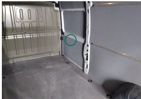
Innenverkleidung Laderaum / Unten Vorne Rechts / Gebrochen
