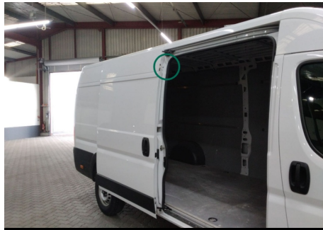
Abdeckung / Oben Rechts / Fehlt
