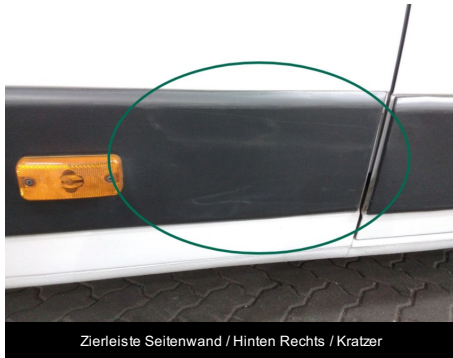
Kotflügelzierleiste / Hinten Rechts / Kratzer
