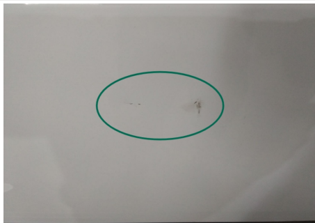
Heckklappe / Kofferraumtür / Unten Rechts / Delle
