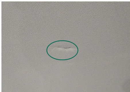
Innenverkleidung Laderaum / Unten Hinten Links / Gebrochen
