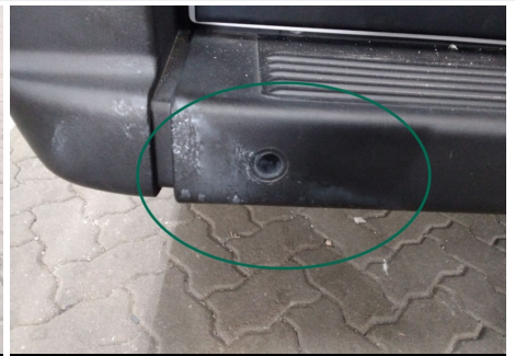
Stoßfänger / Hinten / Kratzer
