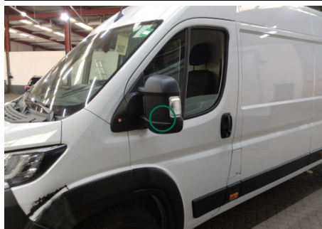
Außenspiegelkappe / Links / Kratzer
