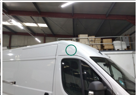
Dachholm / Vorne Rechts / Kratzer
