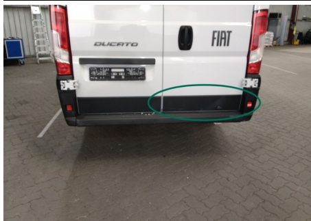
Zierleiste Heckklappe / Unten Rechts / Fleck
