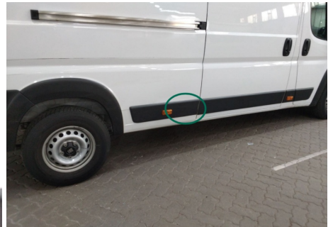
Zierleiste Seitenwand / Hinten Rechts / Kratzer
