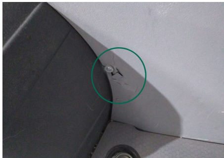
Innenverkleidung Laderaum / Links / Gebrochen
