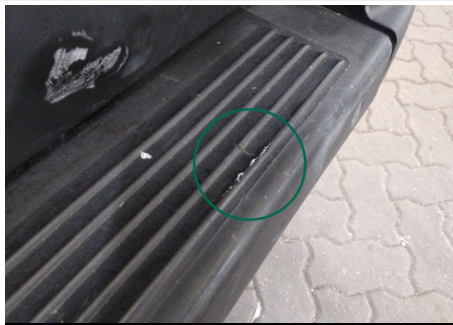
Stoßfänger / Hinten / Kratzer
