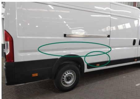
Seitenwand / Unten Hinten Rechts / Schlecht Repariert
