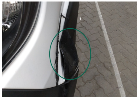
Kotflügelzierleiste / Vorne Links / Delle
