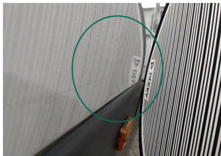
Seitenwand / Unten Hinten Rechts / Schlecht Repariert
