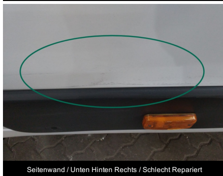
Seitenwand / Unten Hinten Rechts / Schlecht Repariert
