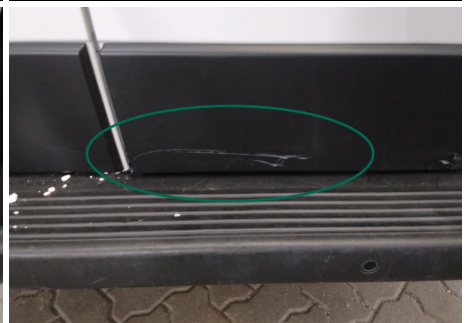
Zierleiste Heckklappe / Unten Rechts / Fleck
