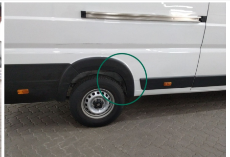
Kotflügelzierleiste / Hinten Rechts / Kratzer
