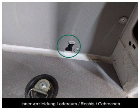
Innenverkleidung Laderaum / Rechts / Gebrochen
