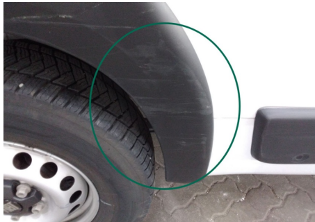
Kotflügelzierleiste / Hinten Rechts / Kratzer
