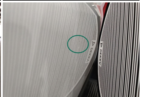
Heckklappe / Kofferraumtür / Unten Rechts / Delle
