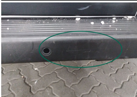
Stoßfänger / Hinten / Kratzer
