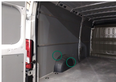
Innenverkleidung Laderaum / Links / Gebrochen
