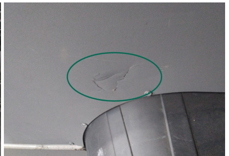
Innenverkleidung Laderaum / Links / Gebrochen
