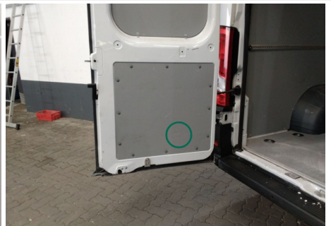
Innenverkleidung Laderaum / Unten Hinten Links / Gebrochen
