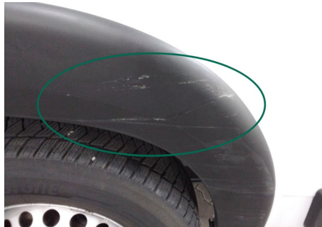
Kotflügelzierleiste / Hinten Rechts / Kratzer
