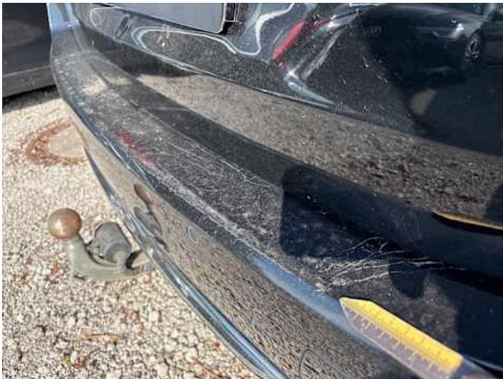
Stoßstange hinten (Kratzer)
