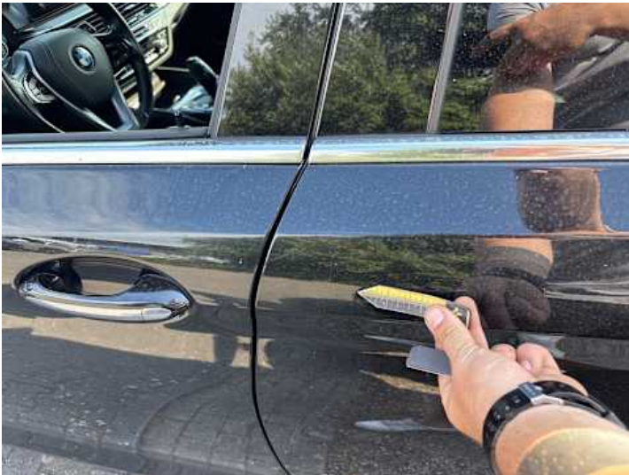
Türe hinten links (Kratzer)
