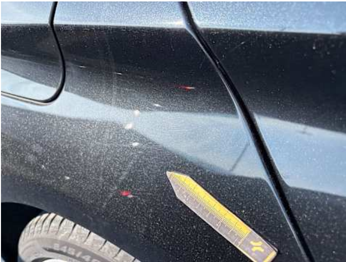
Seitenteil hinten rechts (Kratzer)
