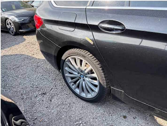
Seitenteil hinten rechts (Kratzer)
