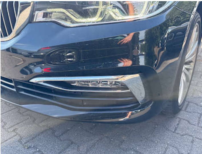
Stoßstange vorne (Steinschlag)
