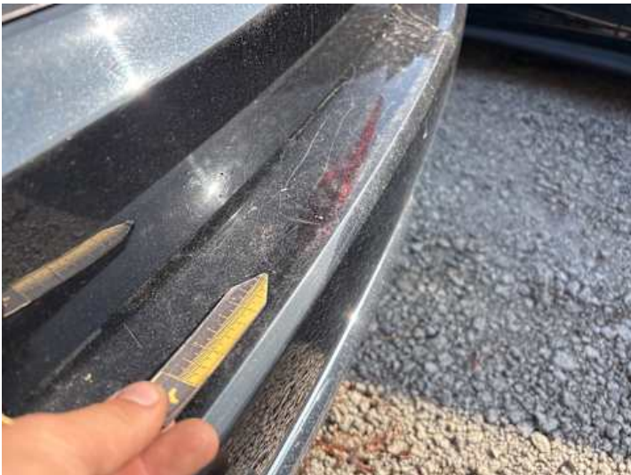
Stoßstange hinten (Kratzer)
