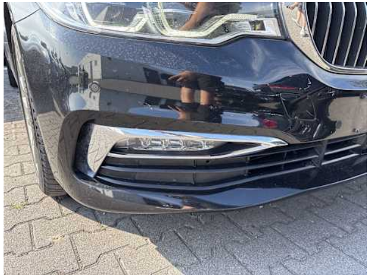
Stoßstange vorne (Steinschlag)
