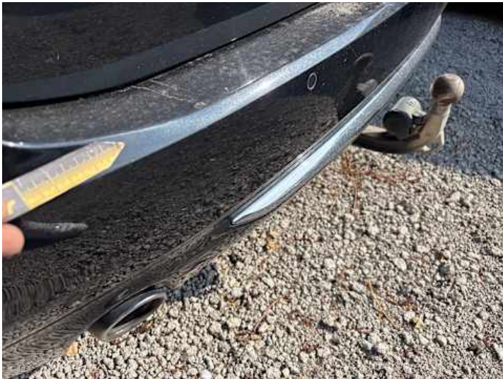
Stoßstange hinten (Kratzer)
