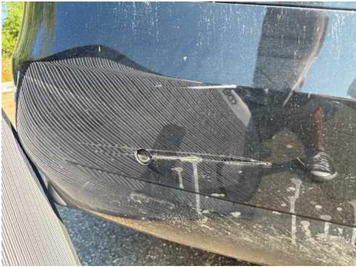
Seitenteil hinten rechts (Kratzer, Verformung)
