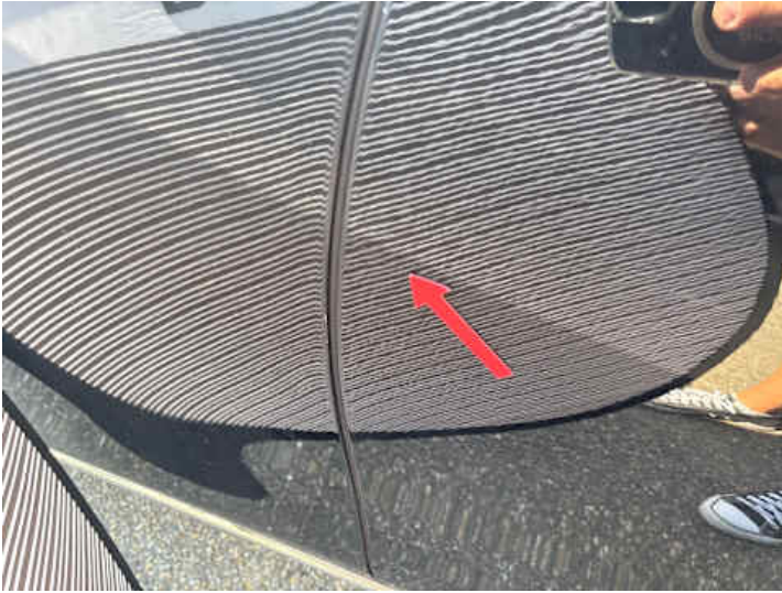
Türe hinten links (Unsachgemäß instand gesetzt)
