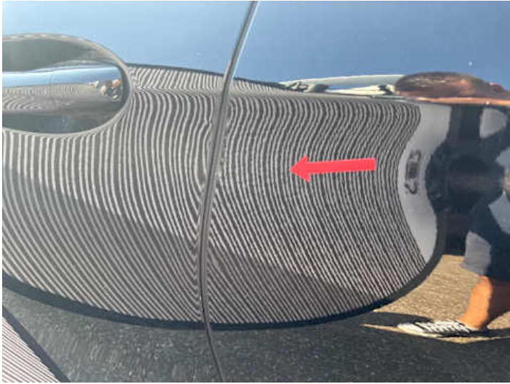
Türe hinten links (Unsachgemäß instand gesetzt)
