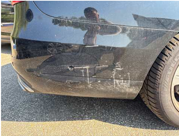
Seitenteil hinten rechts (Kratzer, Verformung)
