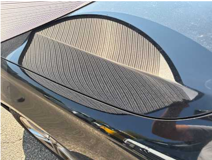
Motorhaube (Unsachgemäß instand gesetzt)
