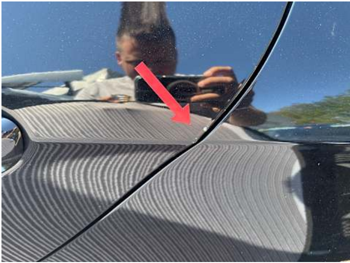
Türe hinten links (Lackschaden)
