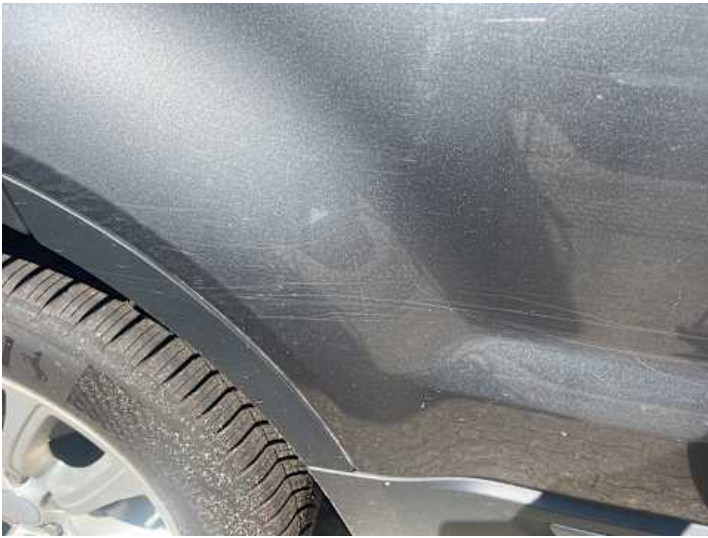
Türe hinten rechts (Kratzer, Lackschaden)
