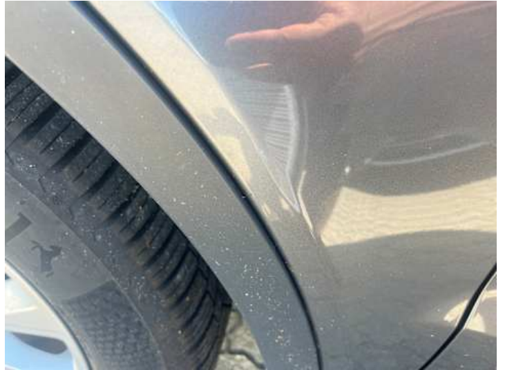
Kotflügel vorne links (Kratzer, Lackschaden)
