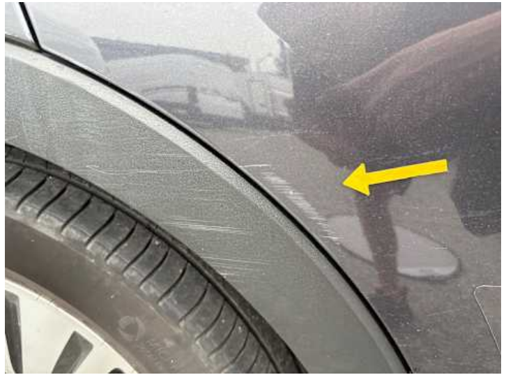
Türe hinten rechts (Delle, Kratzer)
