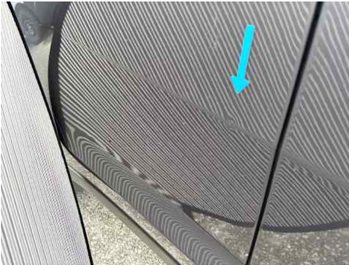
Türe hinten rechts (Delle, Kratzer)
