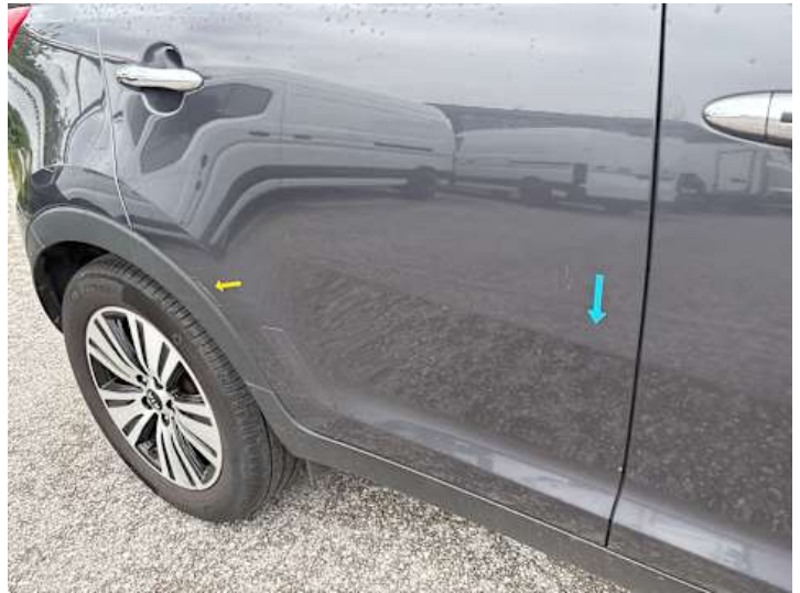
Türe hinten rechts (Delle, Kratzer)
