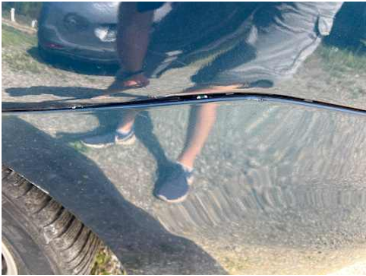
Stoßstange hinten (Spaltmaße ungenau, Lackschaden)
