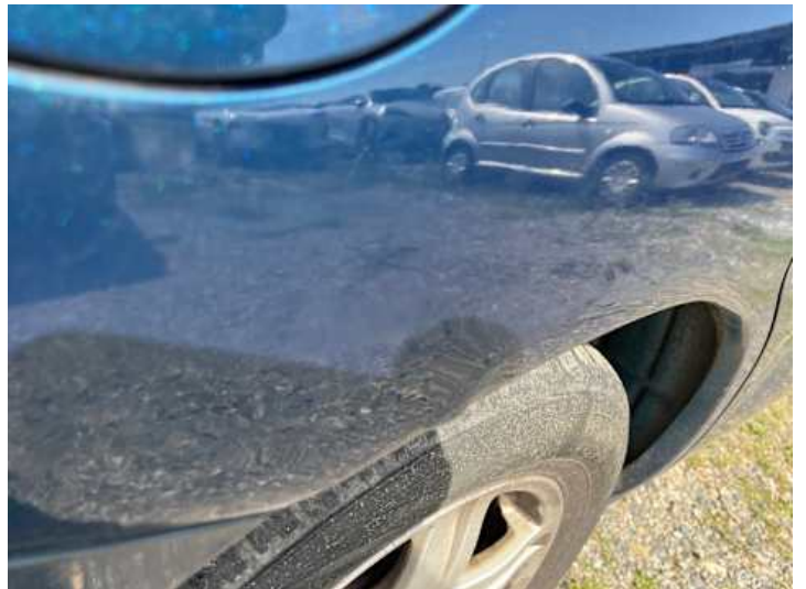
Seitenteil hinten rechts (Rost, Unsachgemäß instand gesetzt)
