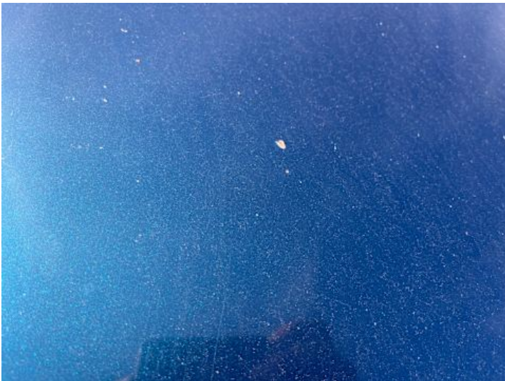
Motorhaube (Steinschlag, Rost)
