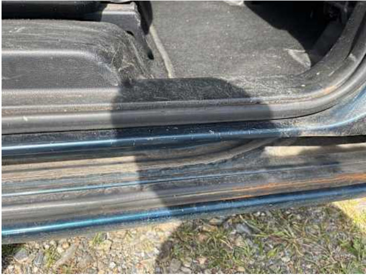
Schweller rechts (Kratzer, Rost)
