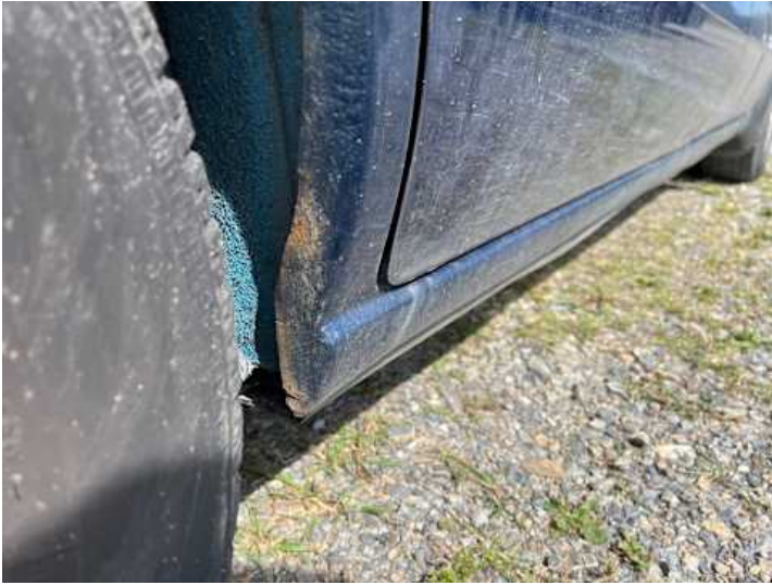
Schweller rechts (Kratzer, Rost)
