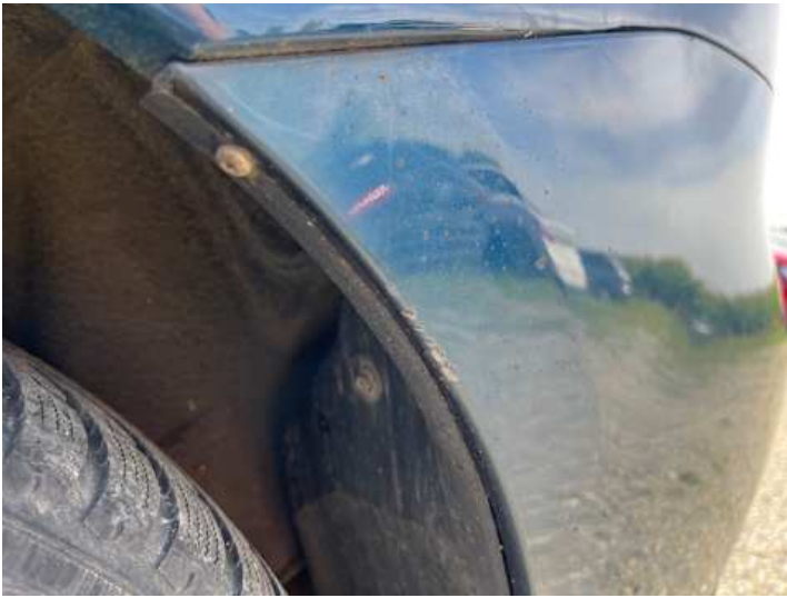
Stoßstange hinten (Spaltmaße ungenau, Lackschaden)
