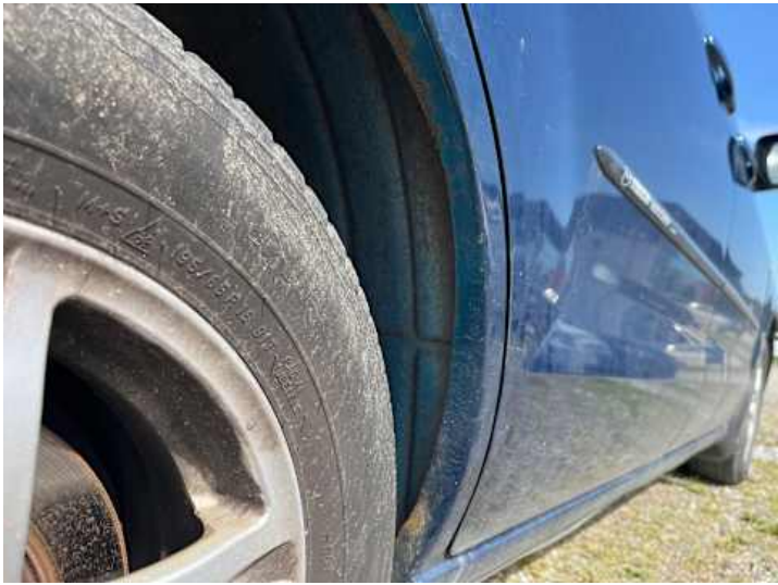
Seitenteil hinten rechts (Rost, Unsachgemäß instand gesetzt)
