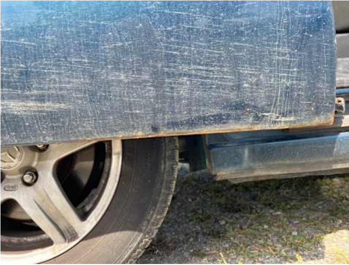
Türe hinten rechts (Rost)
