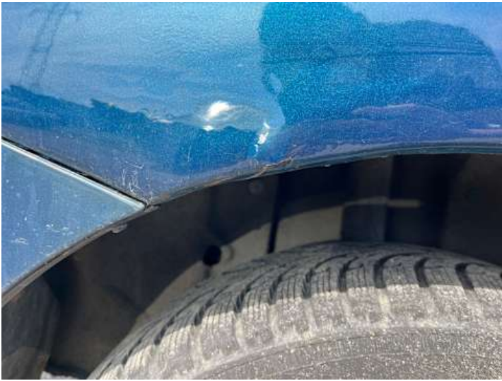
Seitenteil hinten rechts (Rost, Unsachgemäß instand gesetzt)
