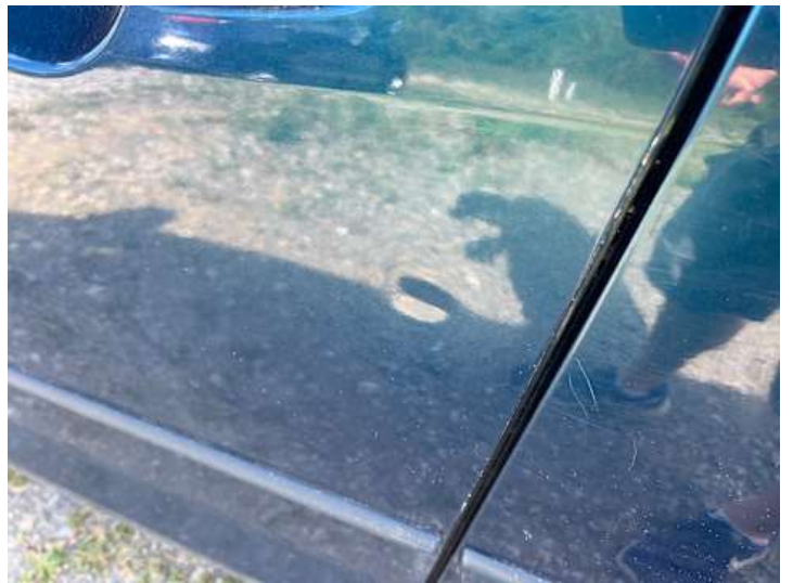
Fahrtür (Kratzer, Delle)
