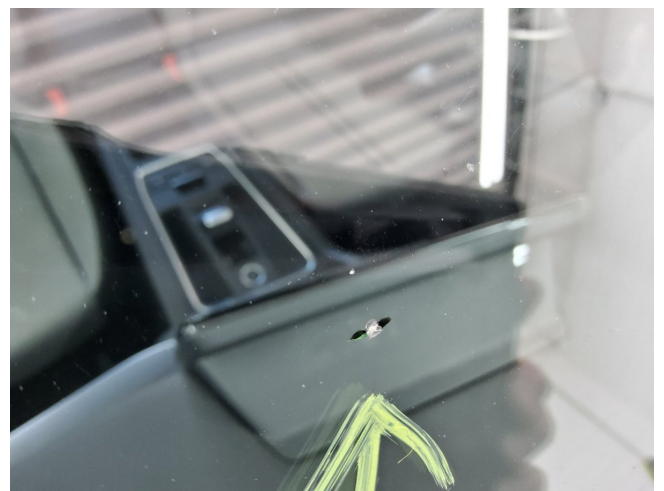
Windschutzscheibe Steinschlag mit Rissbildung (DEKRA)
