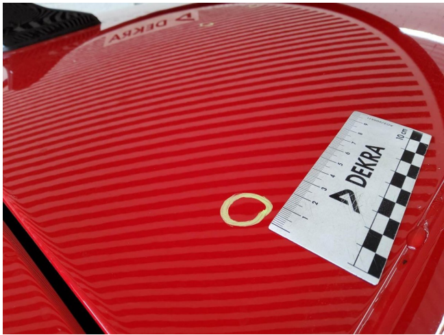
Dach, mehrfach eingedellt, drücken (DEKRA)
