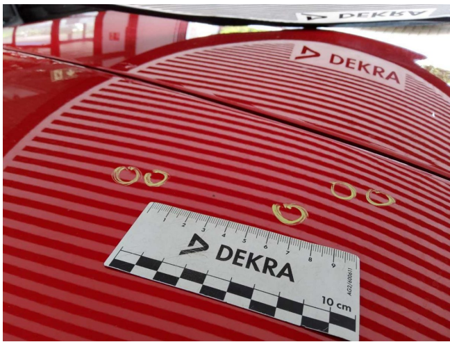
Dach, mehrfach eingedellt, drücken (DEKRA)
