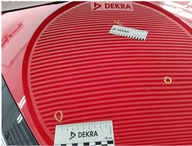
Dach, mehrfach eingedellt, drücken (DEKRA)
