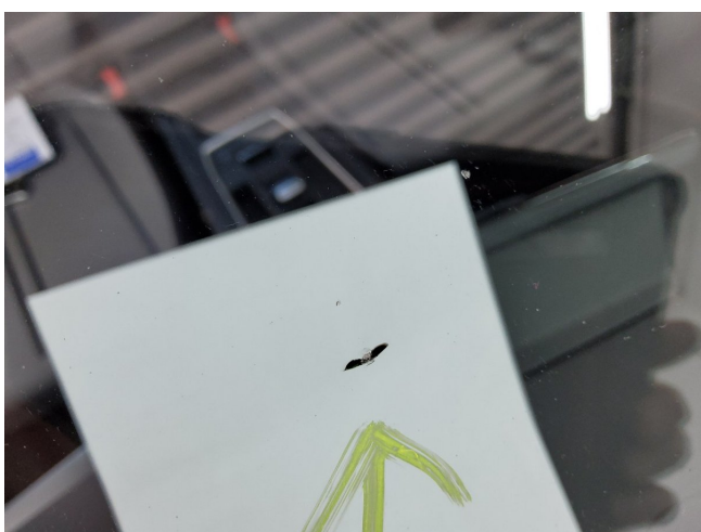
Windschutzscheibe Steinschlag mit Rissbildung (DEKRA)
