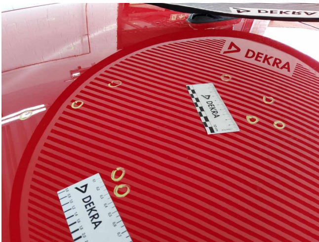
Dach, mehrfach eingedellt, drücken (DEKRA)
