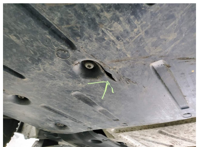
Motorabdeckung unten beschädigt (DEKRA)
