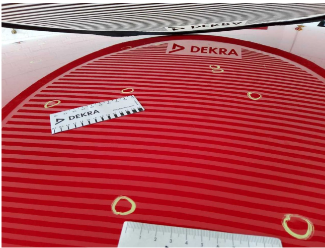
Dach, mehrfach eingedellt, drücken (DEKRA)
