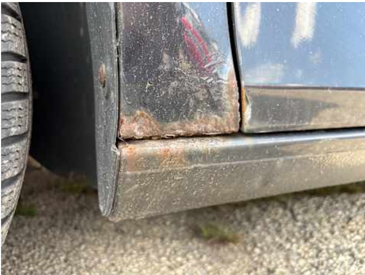
Schweller links (Rost)
