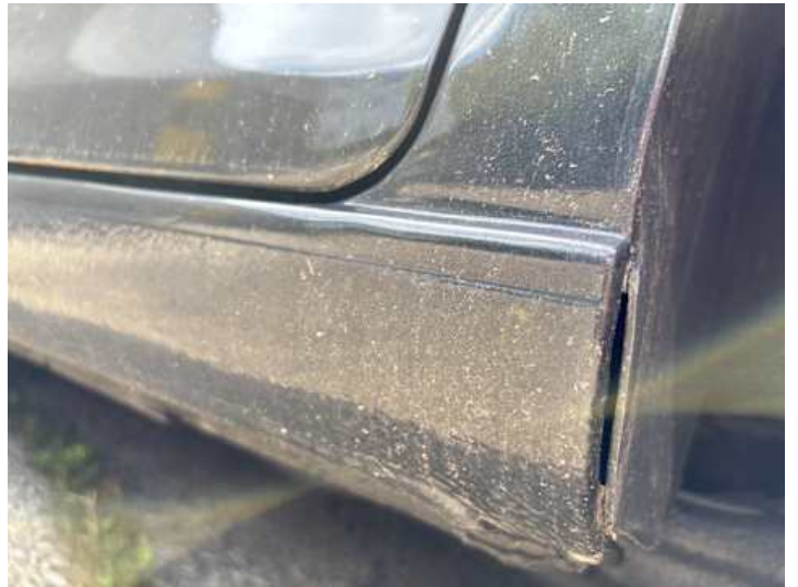
Schweller links (Rost)
