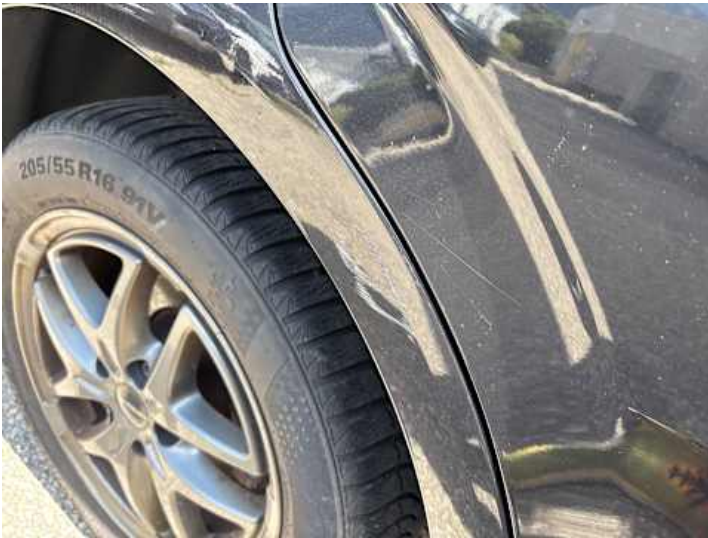
Seitenteil hinten rechts (Kratzer, Verformung)
