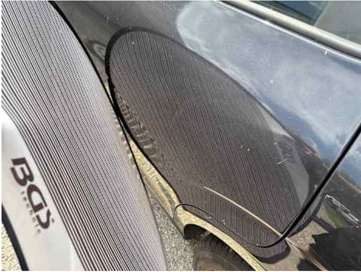
Türe hinten links (Unsachgemäß instand gesetzt)
