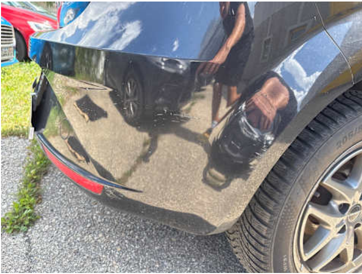
Stoßstange hinten (Kratzer)
