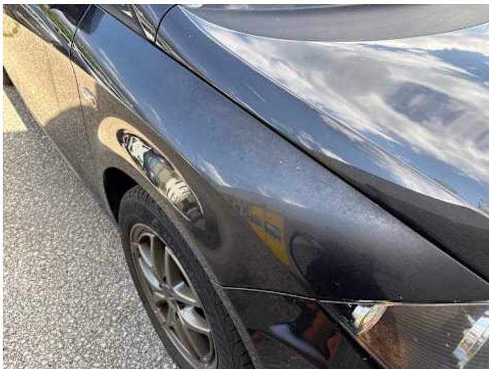
Kotflügel vorne rechts (Ausgeblichen/Matt)
