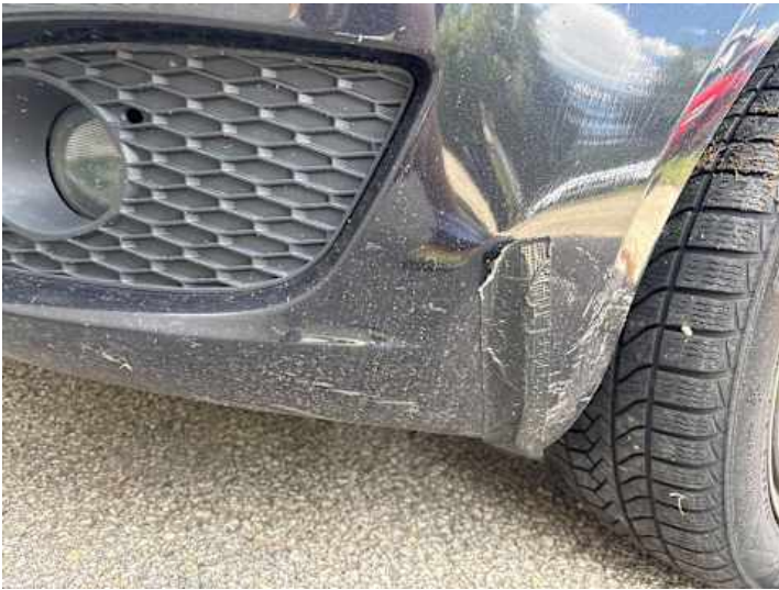
Stoßstange vorne (Verformung, Kratzer, Riss/Bruch)
