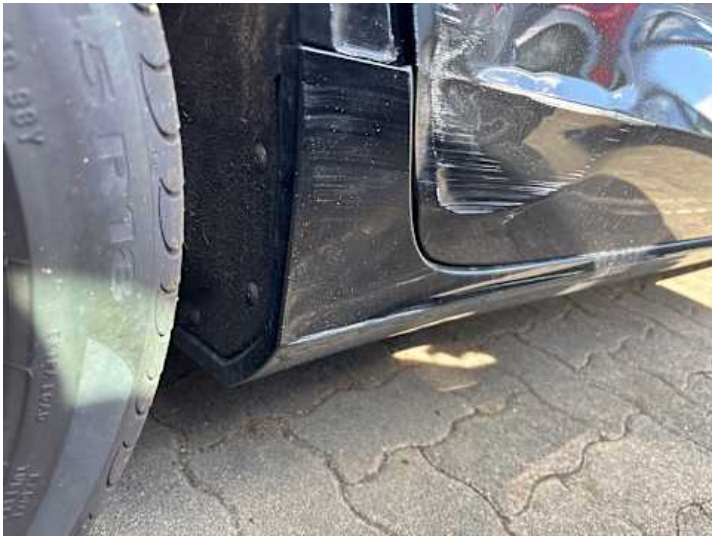
Schweller rechts (Lackschaden, Verformung)
