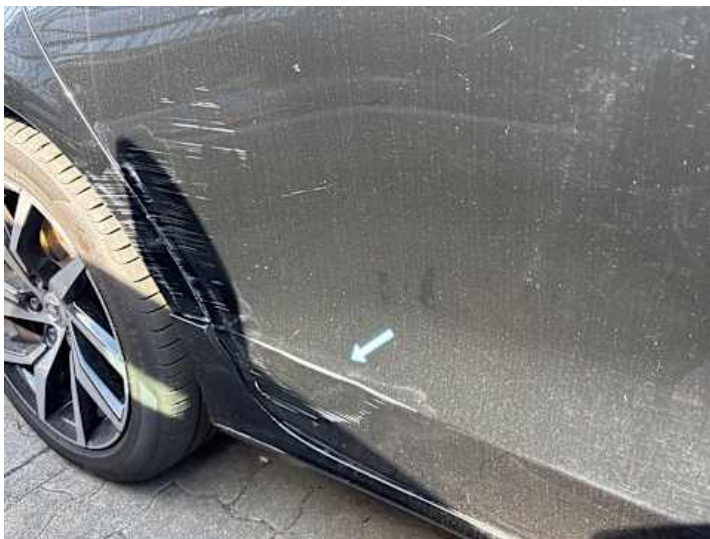
Türe hinten rechts (Delle, Lackschaden)
