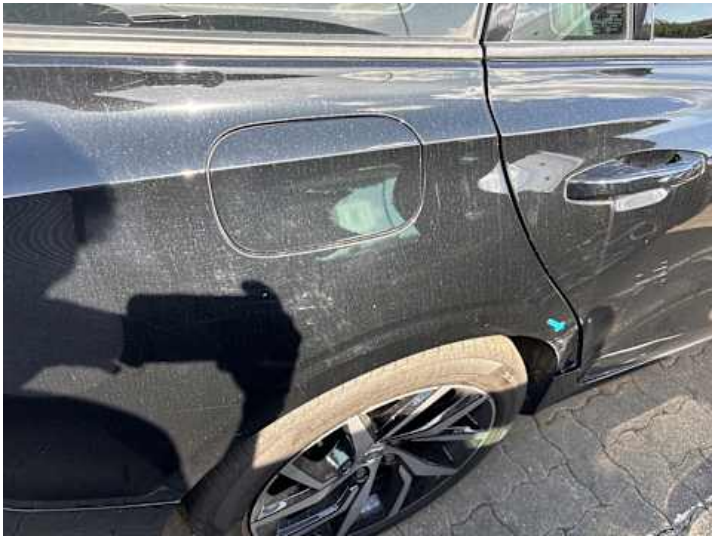
Seitenteil hinten rechts (Delle, Lackschaden, Spaltmaße ungenau)
