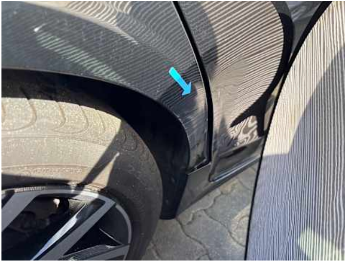
Seitenteil hinten rechts (Delle, Lackschaden, Spaltmaße ungenau)
