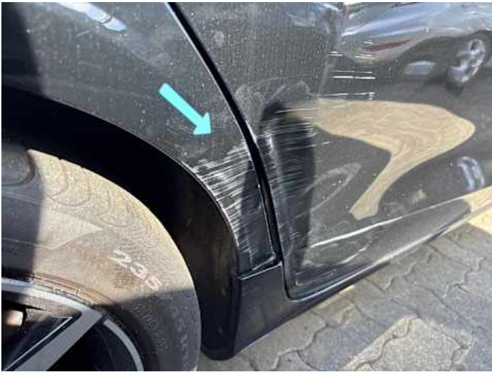
Seitenteil hinten rechts (Delle, Lackschaden, Spaltmaße ungenau)
