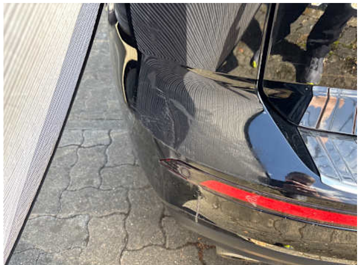
Stoßstange hinten (Lackschaden, Verformung, Unsachgemäß instand gesetzt)
