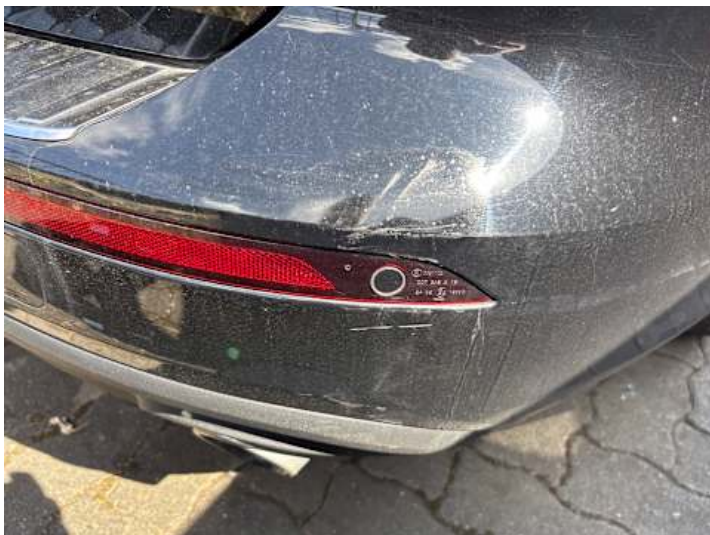
Stoßstange hinten (Lackschaden, Verformung, Unsachgemäß instand gesetzt)
