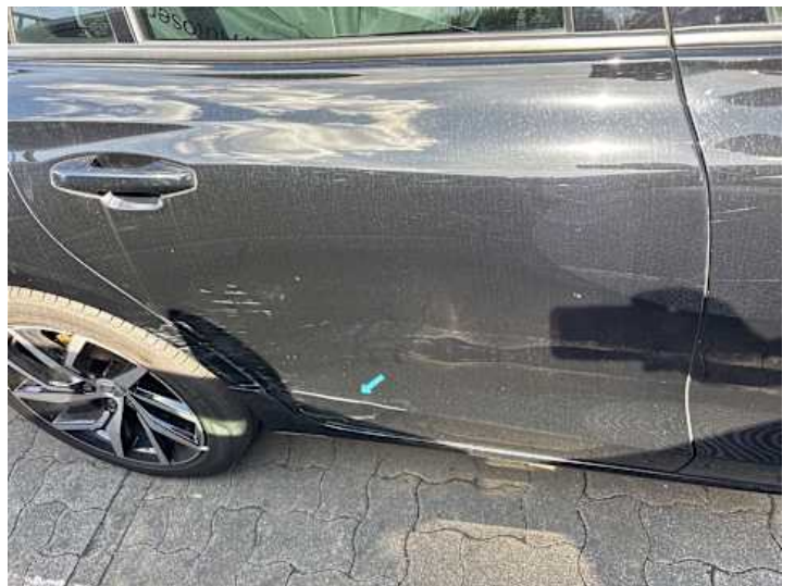
Türe hinten rechts (Delle, Lackschaden)
