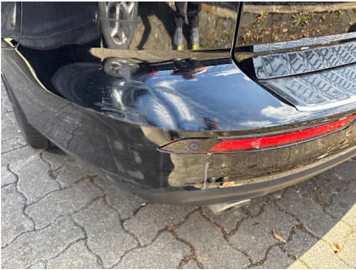
Stoßstange hinten (Lackschaden, Verformung, Unsachgemäß instand gesetzt)
