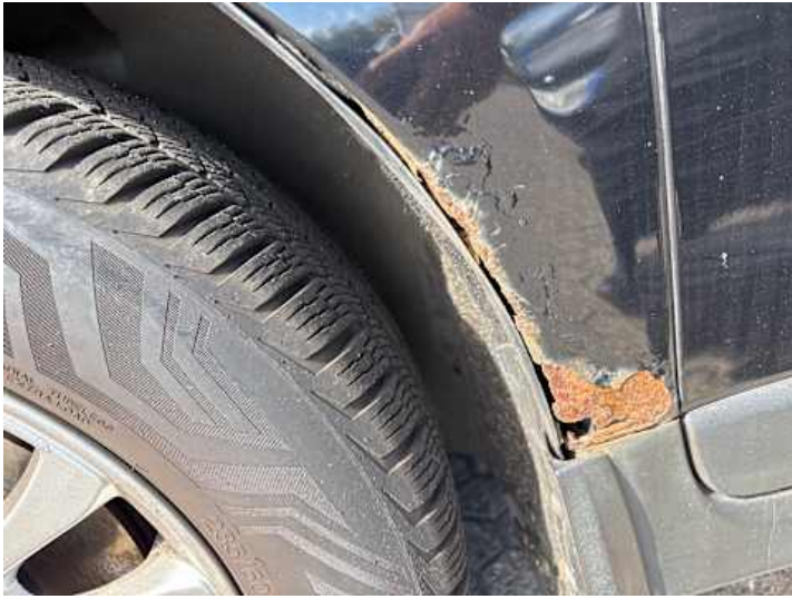
Kotflügel vorne links (Rost, Lackschaden)
