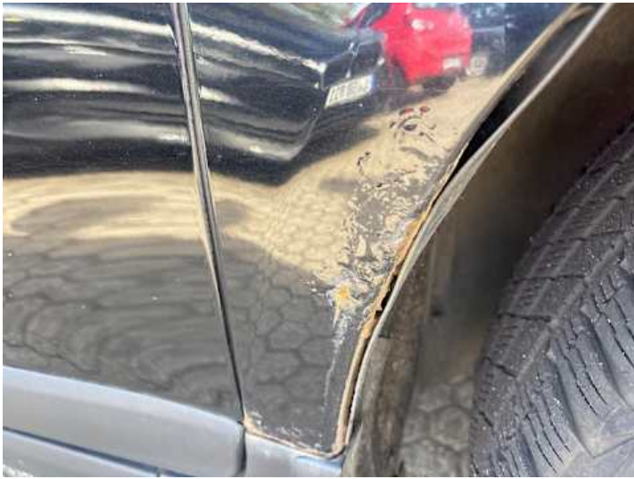
Kotflügel vorne rechts (Rost, Kratzer)
