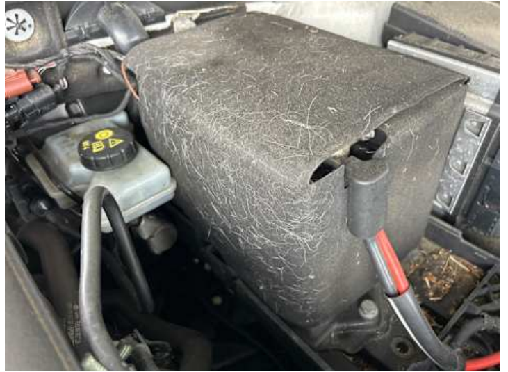
Motorhaube (Anderer Schaden): Marderbiss
