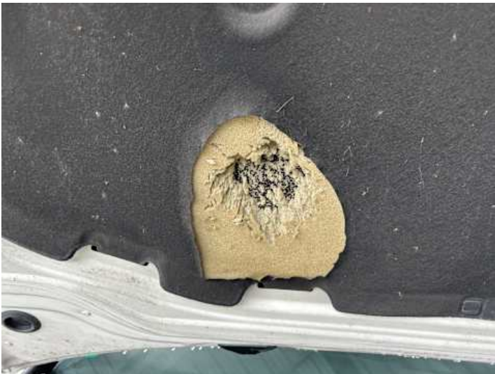
Motorhaube (Anderer Schaden): Marderbiss
