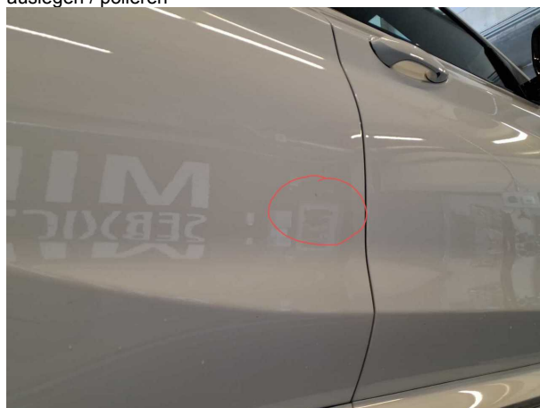
Beschädigung 4: Tür hinten rechts: Tür - Delle / Lackschaden - sanft instandsetzen
