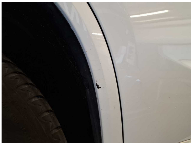
Beschädigung 6: Seitenwand rechts: Radlauf - verkratzt / verschürft - lackieren
