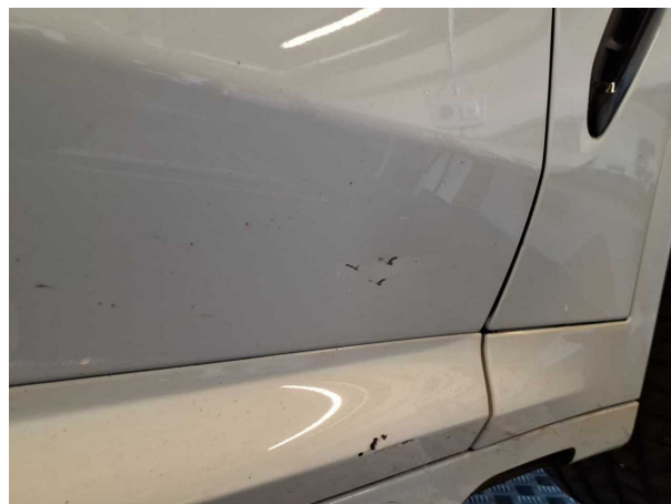
Beschädigung 10: Tür vorn rechts: Tür - Delle / Lackschade... instandsetzen und lackieren
