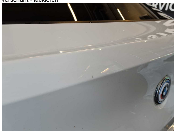
Beschädigung 11: Heckklappe/-tür: Heckklappe - verkratzt / verschürft - lackieren
