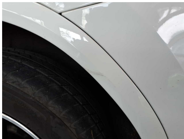
Beschädigung 2: Seitenwand links: Radlauf - Kratzer - auslegen / polieren
