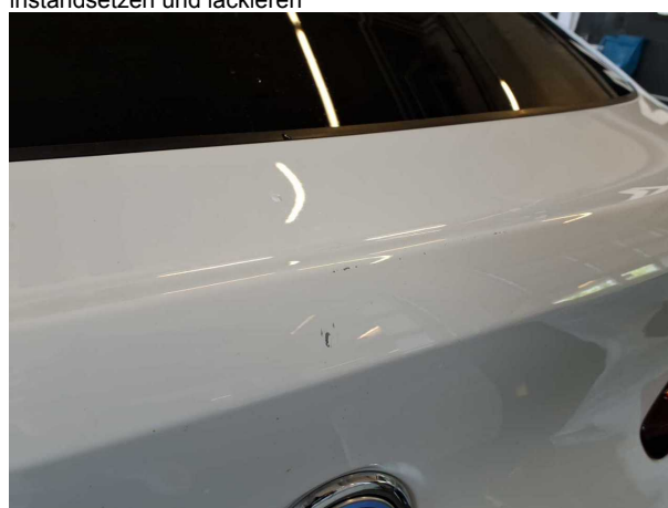
Beschädigung 11: Heckklappe/-tür: Heckklappe - verkratzt / verschürft - lackieren
