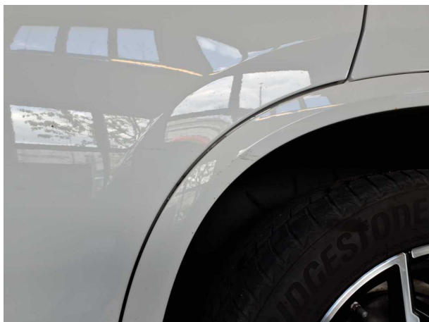
Beschädigung 2: Seitenwand links: Radlauf - Kratzer - auslegen / polieren
