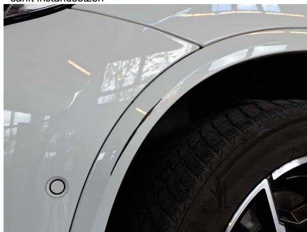
Beschädigung 5: Kotflügel links: Radlauf - verkratzt / verschürft - lackieren
