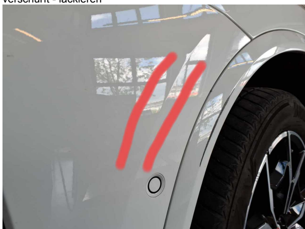
Beschädigung 8: Stossfänger vorn: Stossfänger vorn (Ecke links) - verkratzt / verschürft - Smart Repair
