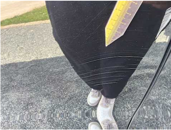
Türe hinten links (Kratzer)
