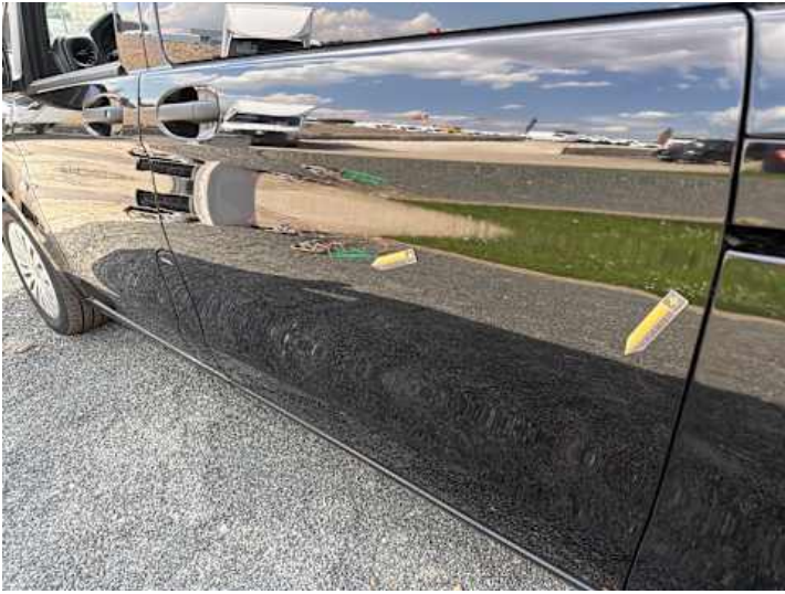
Türe hinten links (Delle, Kratzer)
