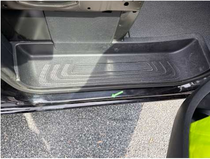
Schweller rechts (Kratzer)
