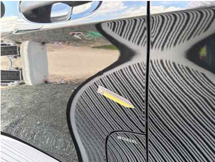
Fahrtür (Delle, Kratzer)
