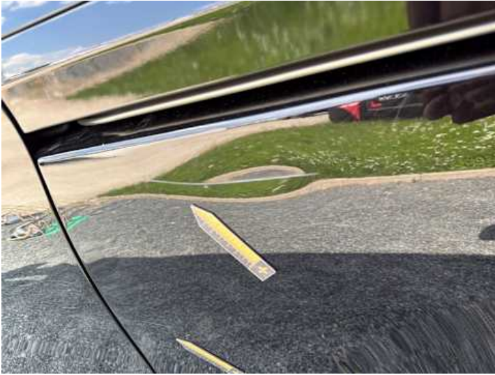
Seitenteil hinten links (Kratzer, Verformung)
