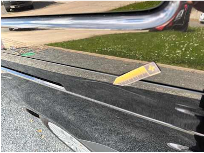
Seitenteil hinten links (Kratzer, Verformung)
