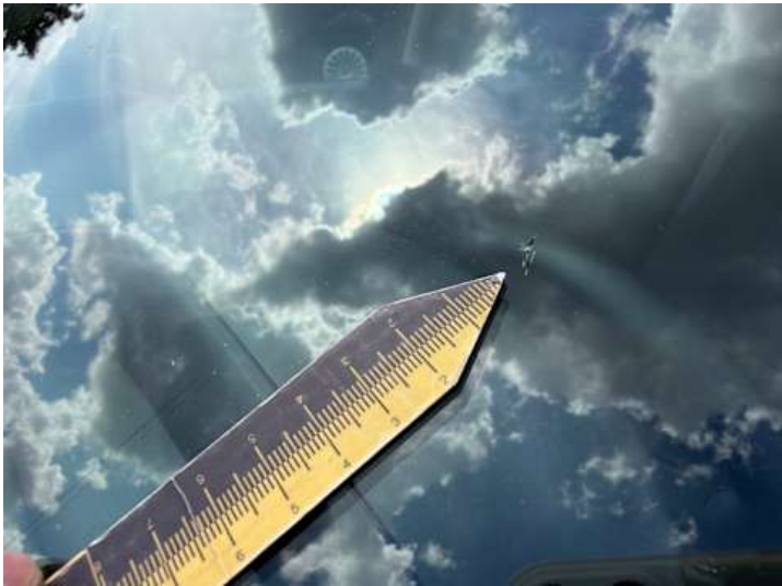
Windschutzscheibe (Steinschlag, Riss/Bruch)
