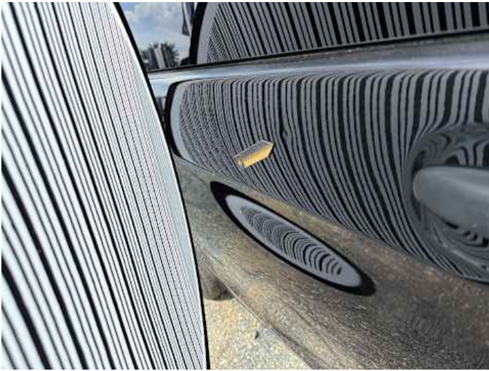
Türe hinten rechts (Delle)
