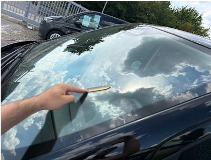
Windschutzscheibe (Steinschlag, Riss/Bruch)
