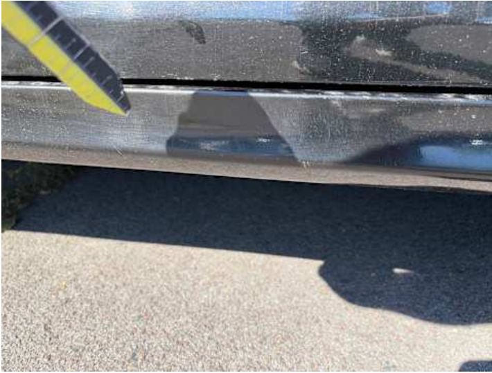
Schweller links (Lackschaden, Kratzer)
