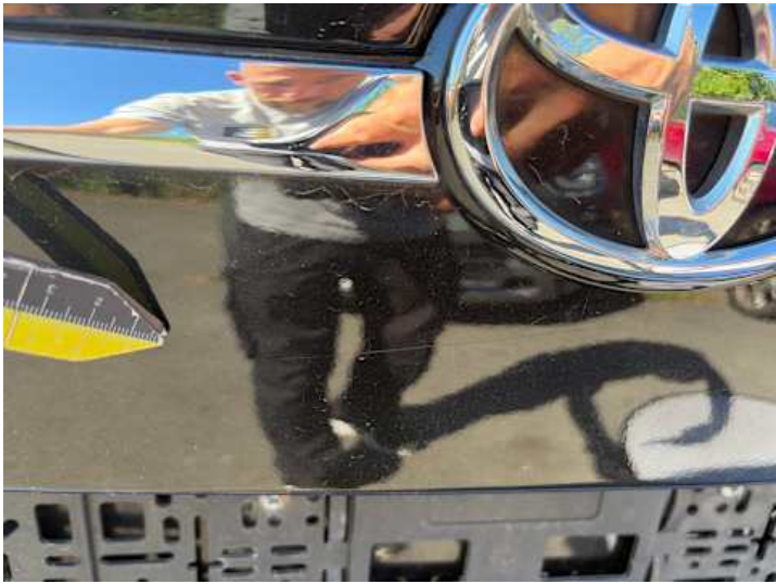
Heckklappe (Lackschaden, Kratzer)
