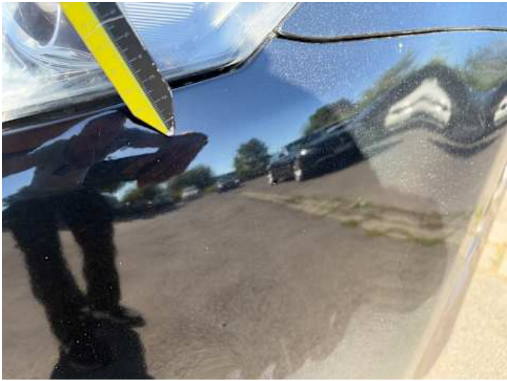
Stoßstange vorne (Lackschaden, Kratzer)
