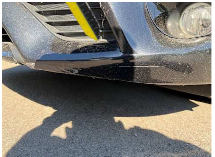
Stoßstange vorne (Lackschaden, Kratzer)
