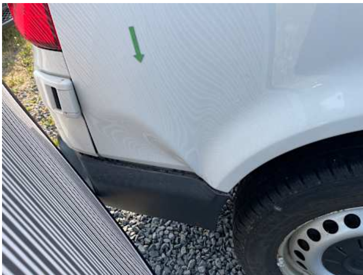
Seitenteil hinten rechts (Verformung)
