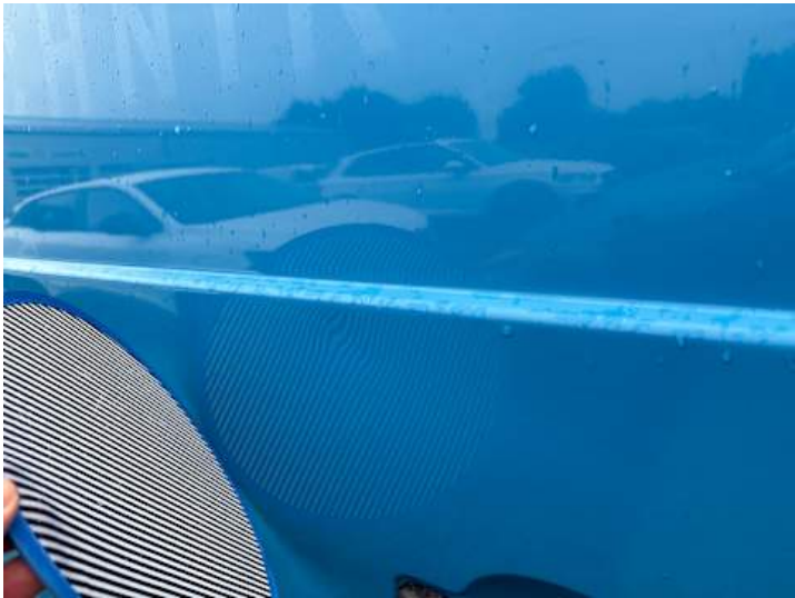
Türe hinten rechts (Kratzer, Delle)
