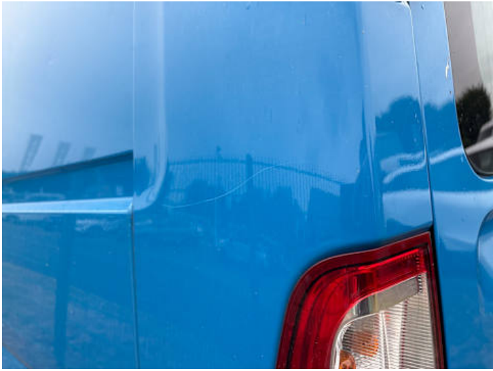
Seitenteil hinten links (Kratzer, Delle)
