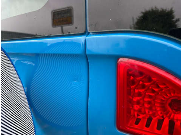
Heckklappe (Kratzer, Delle)
